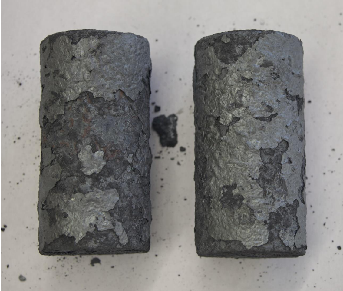
Obr. 44 – Povrch vzorku R01 a R02 po pátém cyklu ochlazování (zdroj: autor)
