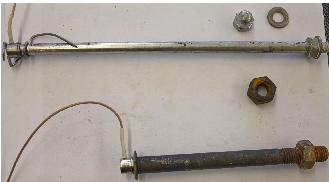
Obr. 34 – Srovnání duralové tyče se závitem a držákem snímače a šroubem. (zdroj: autor)
