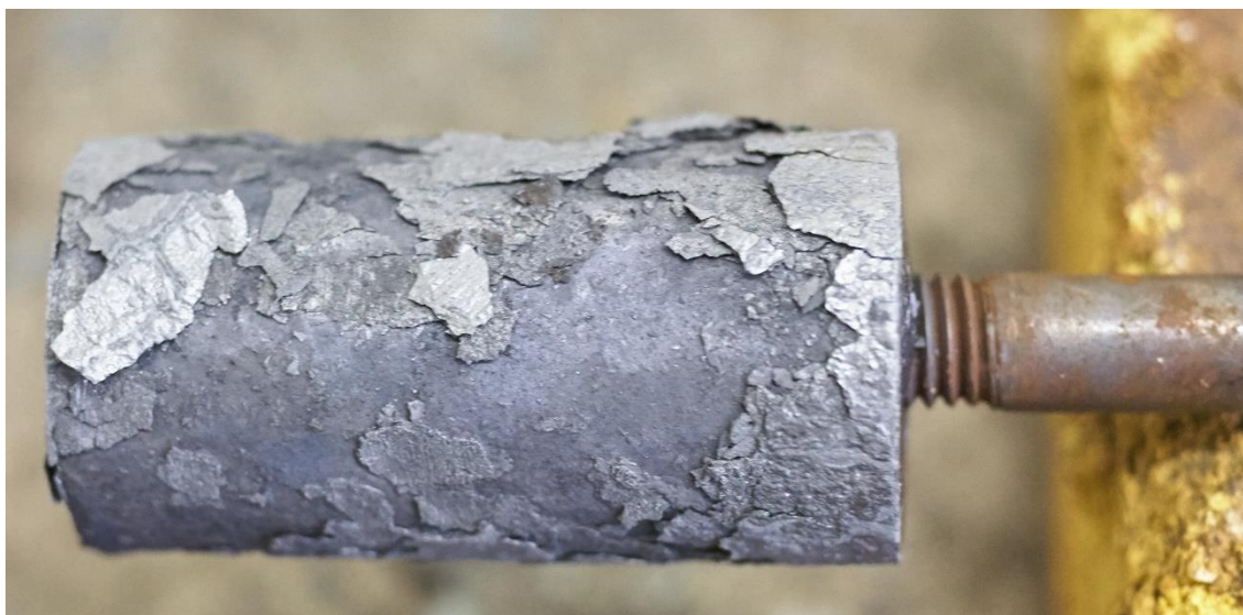
Obr. 42 – Oduhličený vzorek R01 (zdroj: autor)
