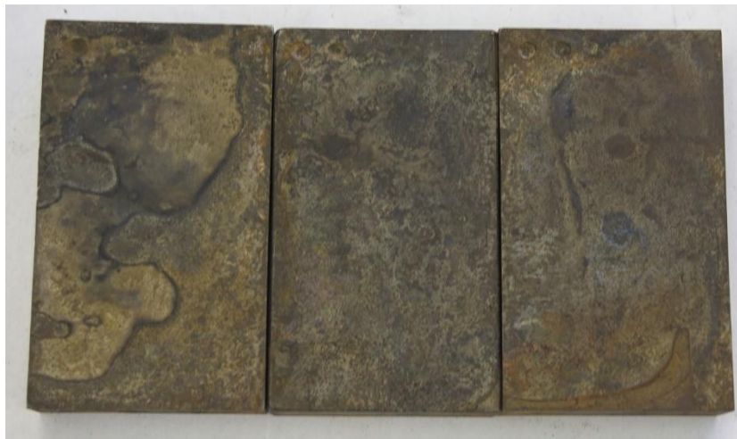
Obr. 37 – Oduhličení povrchu vzorků K01, K02 a K03 po třetím cyklu ochlazování (zdroj: autor).
