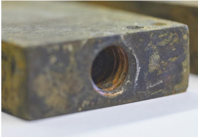
Obr. 36 – Koroze v závitě u vzorku K02 (materiál ČSN 12 050) (zdroj: autor)
