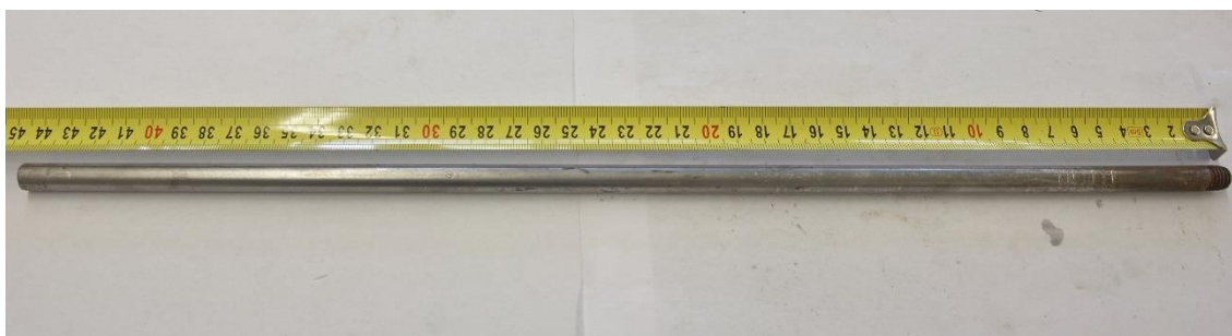
Obr. 27 – Kruhová tyč pro přímé měření AE (zdroj: autor)
