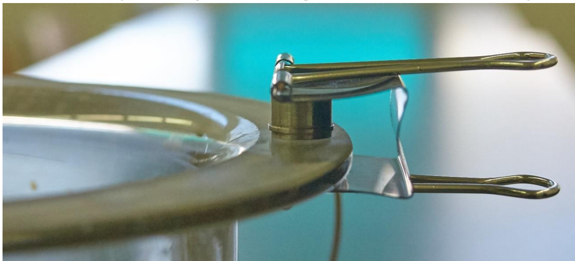
Obr. 33 – Uchycení snímače č. 3 k horní hraně exsikatoru za pomoci kancelářské sponky. (zdroj: autor)
