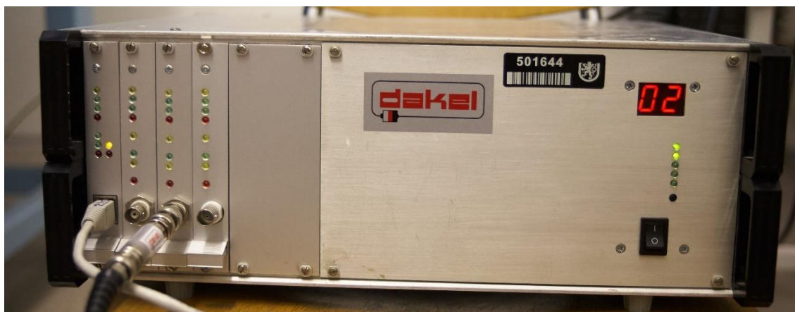
Obr. 10 – Tříkanálová jednotka pro detekci akustické emise (zdroj: autor)
