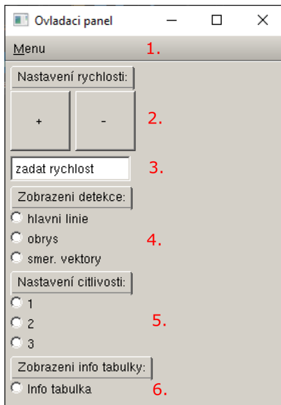
Obr. 4.6: Ovládací panel: 1. Menu připravené pro budoucí použití, 2. Tlačítka pro nastavení rychlosti, 3. Textové okno sloužící pro nastavení rychlosti, 4. Typ zobrazení detekce obličeje v hlavním okně, 5. Nastavení citlivosti, 6. Zobrazení informační tabulky.
