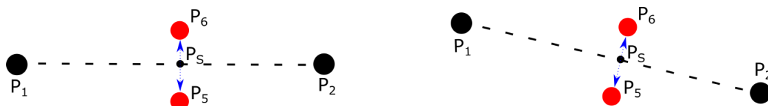
Obr. 4.11: Body pro výpočet náklonu hlavy. P1 – bod koutku pravého oka, P2 – bod koutku levého oka, PS – bod mezi očima, P5 a P6 – nové polohy středového bodu při pohledu vzhůru resp. dolů.
