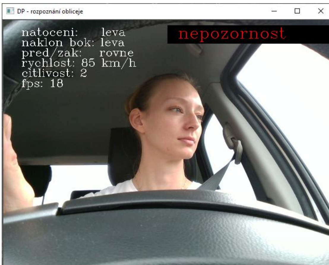
Obr. 4.7: Hlavní okno: (tabulka vlevo) Informace zobrazující: natočení, náklon do boku a předklon nebo záklon hlavy, aktuální rychlost vozidla, zvolená citlivost a fps kamery. (vpravo nahoře) Informace pro varování řidiče na případnou abnormální pozici řidiče.
