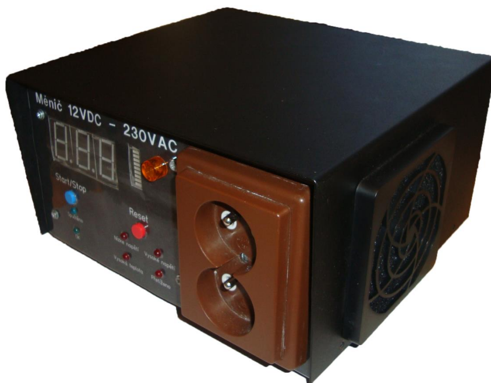
Obr.č.53: Zkompletované zařízení jednofázového střídače 12 VDC/230 VAC, 50 Hz (bakalářská práce)
