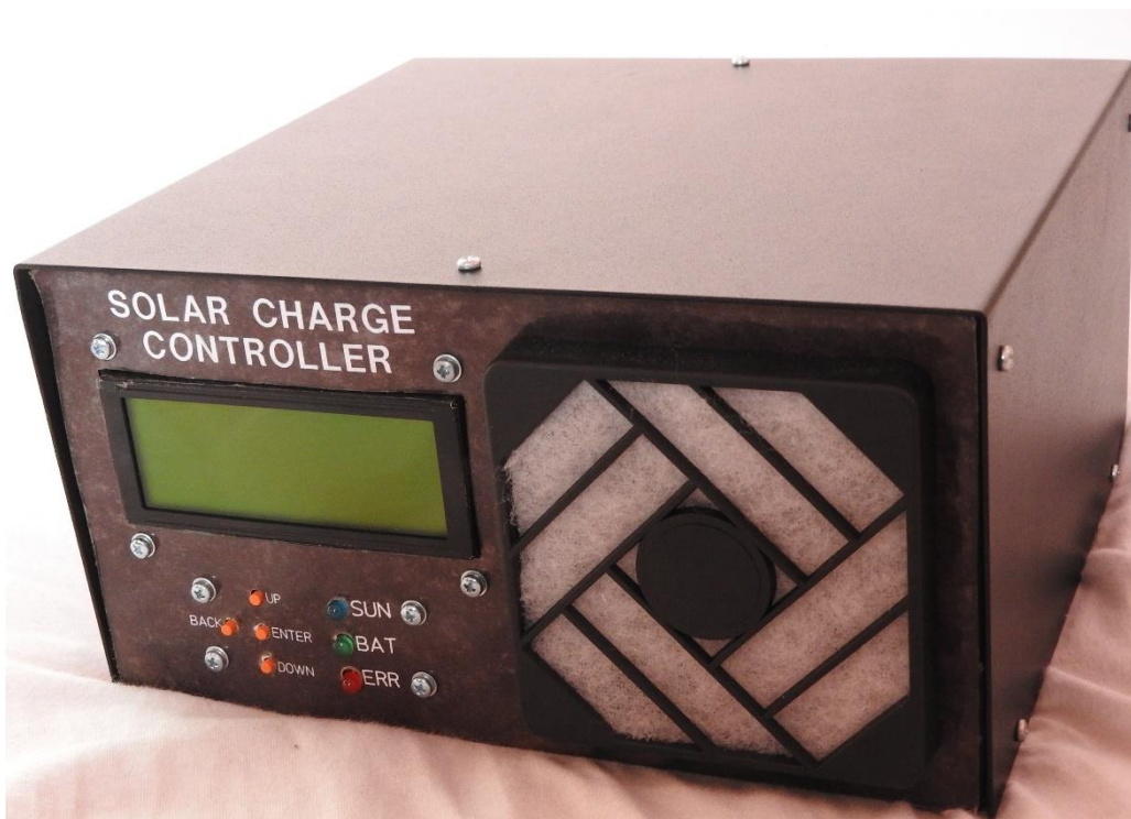
Obr.č.52: Zkompletované zařízení měniče pro malou solární elektrárnu
