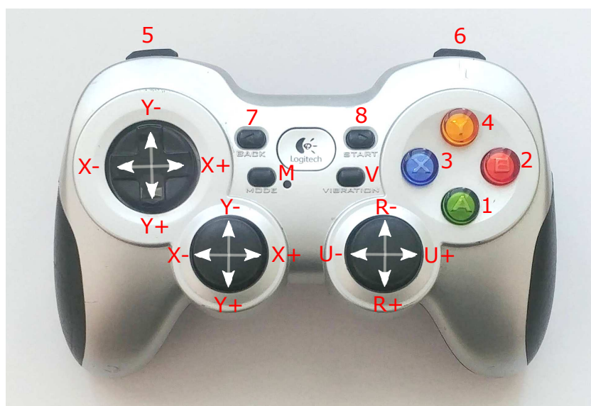
Obr. 4.4: Indexování ovládacích prvků konzole Gamepad joystick
