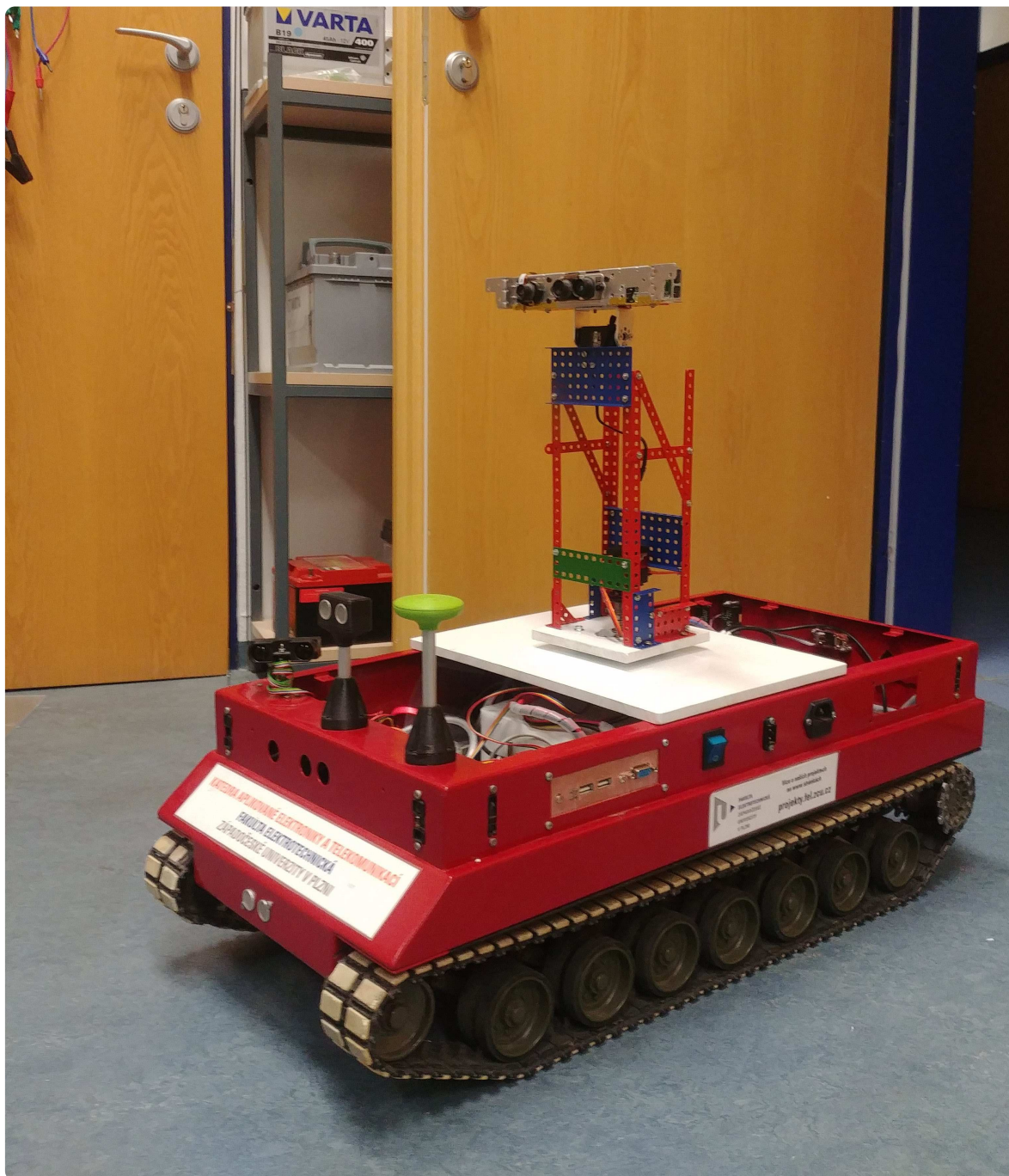
Obr. A.2: Platforma s prototypem věže z Merkuru
