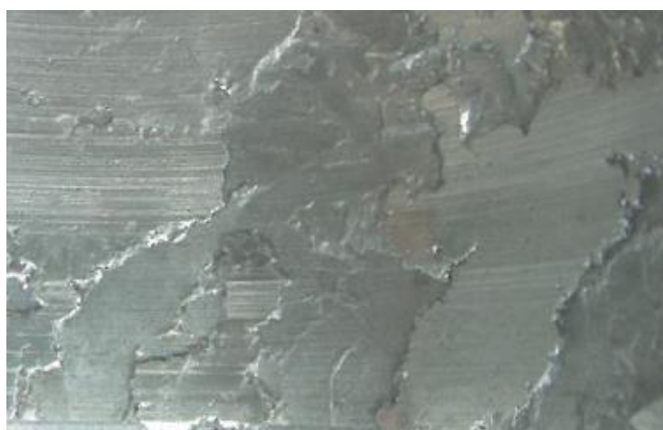
Obr. 6: Fatigue crackings – Cínová kompozice kompletně poškozená únavovými trhlínami – ty jsou způsobené dynamickým namáháním, nebo dlouhodobým „přehříváním“ ložiska. [21]
