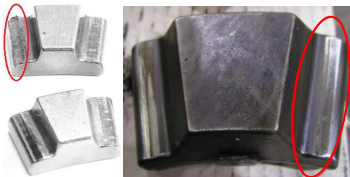
Obr. 27: Opotřebení vahadel v případě nedodržení výše zmíněných zásad [13], [37]
