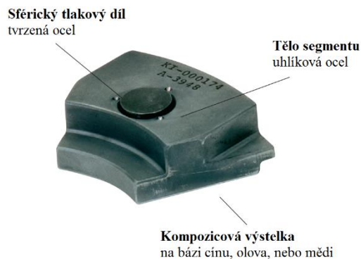
Obr. 16: Části axiálního segmentu [28]
