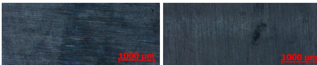
Obr. 127: Vzorek 17 destička, nitridace, 20x zvětšení, - Nerozpoznatelné žádné poškození při 0,5 t zatížení, (vlevo); začínající poškození při 2 t zatížení (vpravo)
