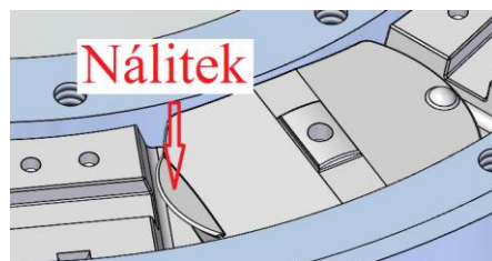
Obr. 39: Nálitok k snadnému vyjmutí vahadla z těla [autor]
