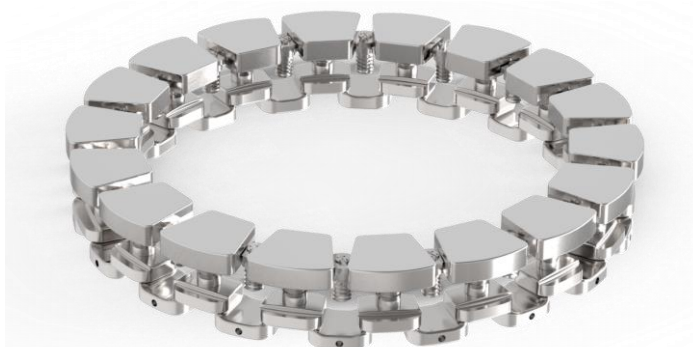
Obr. 40: Sestava vahadel s axiálními naklápěcími segmenty a tlakovým distribučními dílci – princip rozložení [27]
