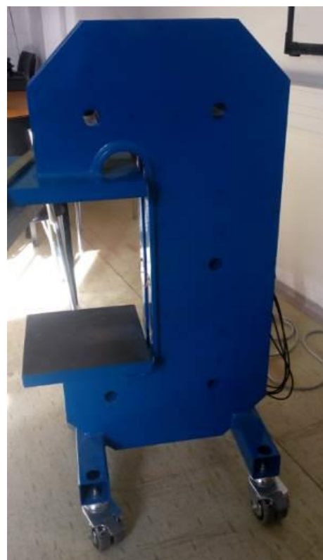
Obr. 90: Základní rám připravený pro montáž držáků
