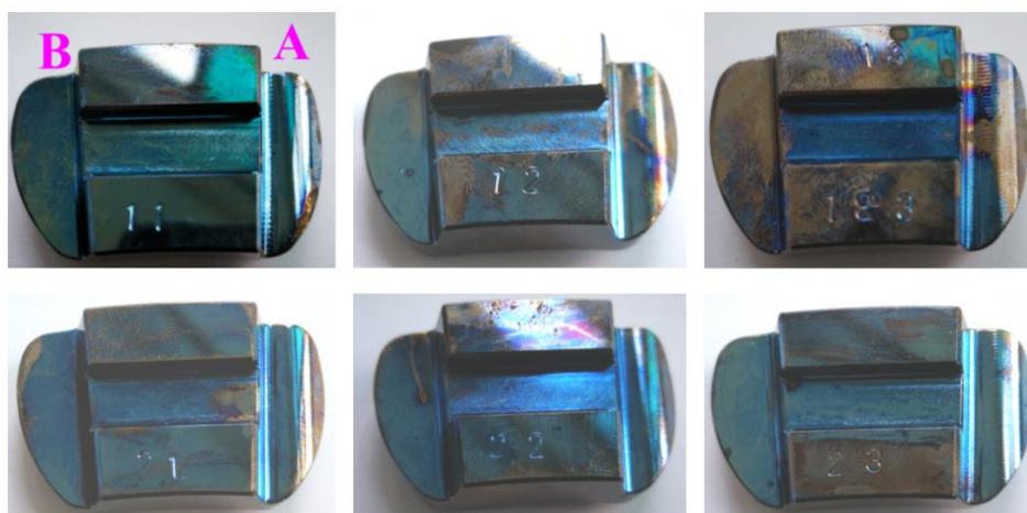
Obr. 145: Vahadlo po niklování
