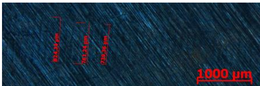
Obr. 121: Vzorek 18 destička, niklovaný, 20x zvětšení, 1t zatížení, měření
