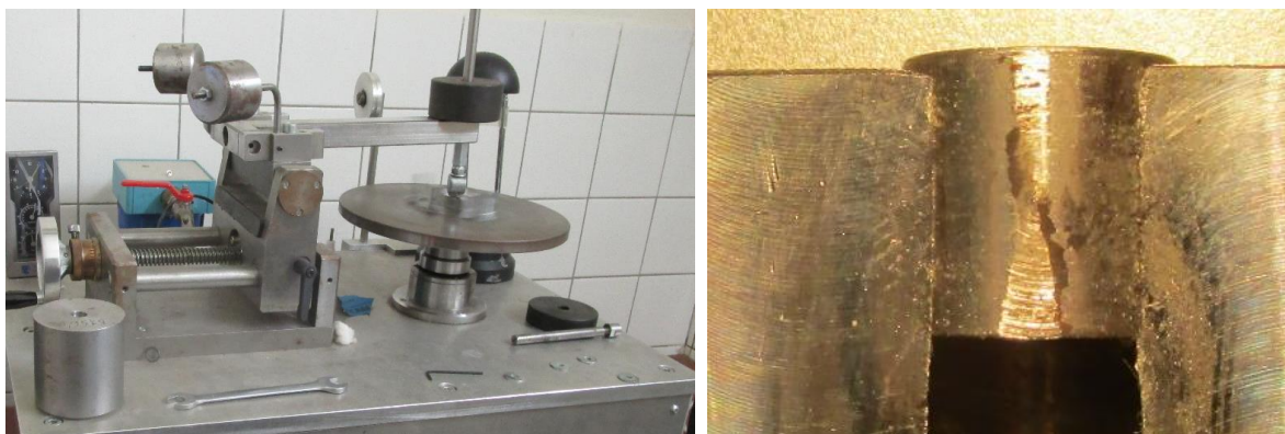
Obr. 80: Testování válečků na tribometru (vlevo); detail opotřebení (vpravo)
