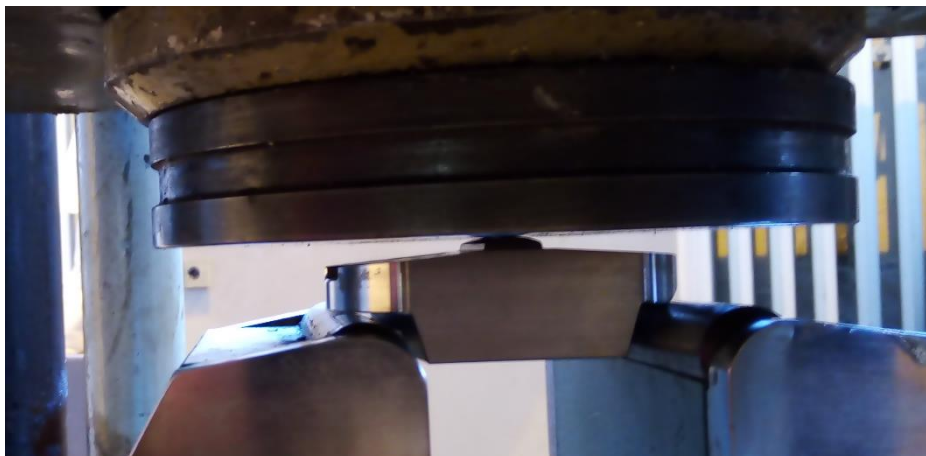
Obr. 147: Ustavení vahadla v lisu
