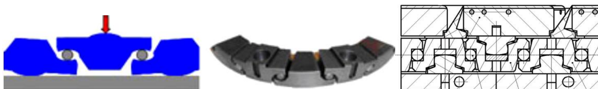
Obr. 35: Sestavy vahadel s vloženým válečkem od různých výrobců [24] [25]
