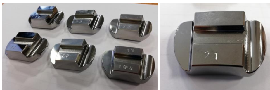
Obr. 144: Vahadla pro omílání. Vpravo detail na vahadlo 2.1.
