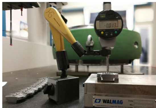
Obr. 46: Měření kritické hodnoty – výšky vahadel
