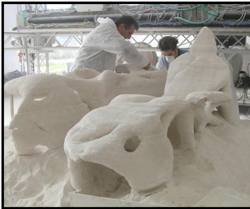
Obr. 19: Odstraňování přebytečného písku po dokončení 3D tisku metodou D-Shape
