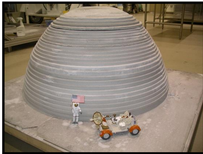
Obr. 16: Model kopule pro základnu na jiné planetě vytištěný metodou Contour Crafting, USA
