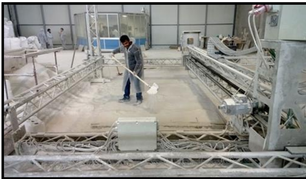
Obr. 18: Ukázka místa pro tisk metodou D-Shape
