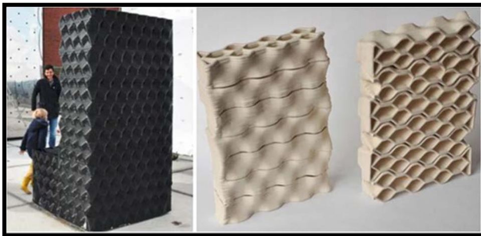
Obr. 24: Ukázky vytištěných prvků metodou Modelu fúzovaného vkladu
