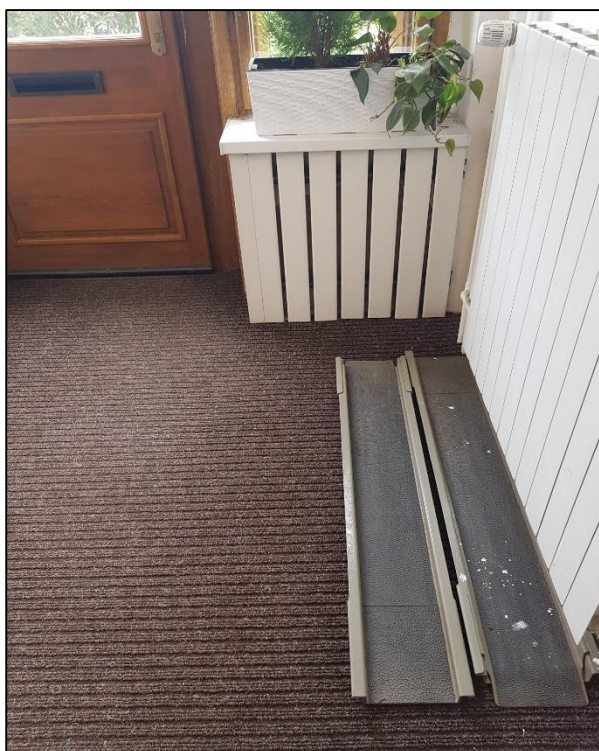
Obrázek 99 - Připravené přenosné nájezdy (v případě návštěvy osoby na vozíku, je možné použít tyto nájezdy s cizí pomocí) v Budově MěÚ 3 , zdroj: autorka DP
