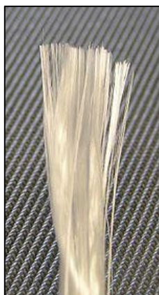
Obr. 3 - Roving vytvořený ze skleněných vláken [5] [Zdroj: http://origin-production.wikiwand.com/cs/Textilie ]
