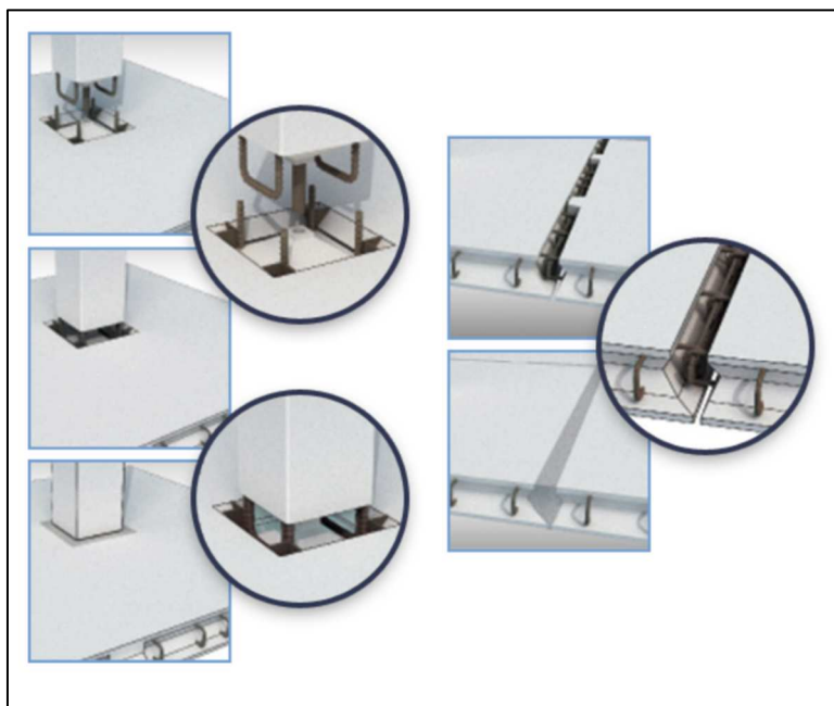
Obr. č.12 - Montážní spoje systému „KUB 2.5“
