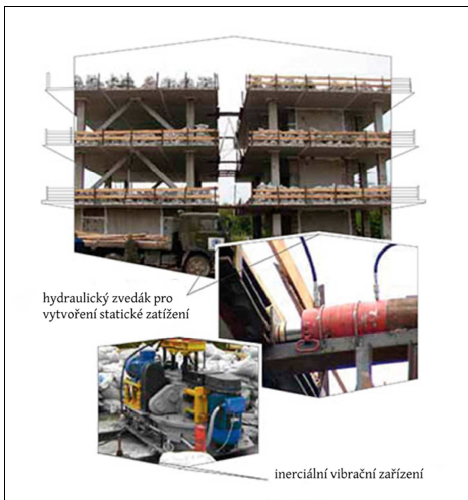
Obr. č. 16 - Fotodokumentace provedení seismické zkoušky „KUB 2.5“
