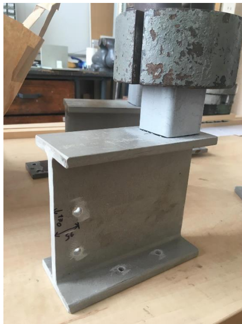
Obrázek č. 15 – Lepení vzorku - zatížení [Zdroj: autor diplomové práce]
