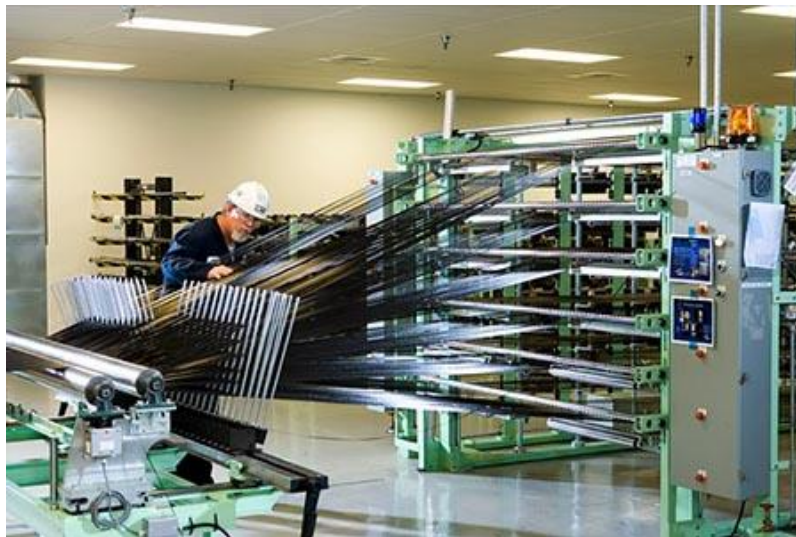
Obrázek č. 6 – Výroba tkanin z uhlíkových vláken
