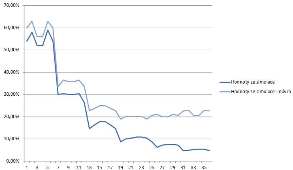
Obrázek 4 - Porovnání hodnot činitele denní osvětlenosti (návrh) v místnosti EU 109
