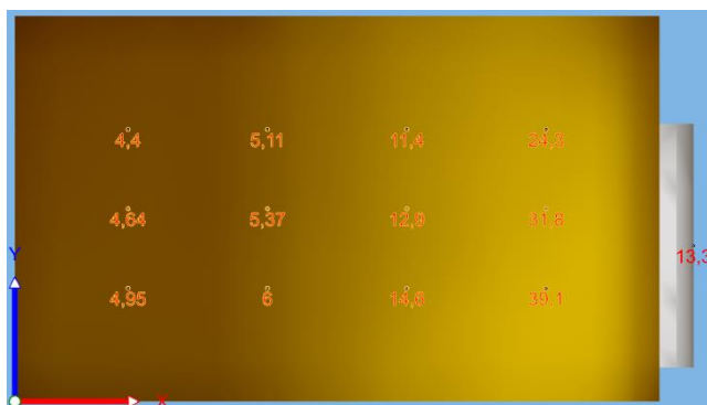
Obrázek 15 - Hodnoty činitele denního osvětlení z modelu místnosti UC 334
