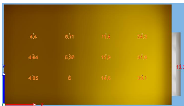
Obrázek 13 - Hodnoty činitele denního osvětlení z modelu místnosti UC 122
