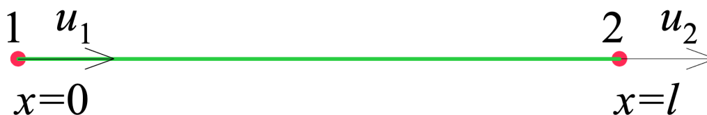
Obrázek 3.6: Posuvy elementu od tahových popř. tlakových sil.
