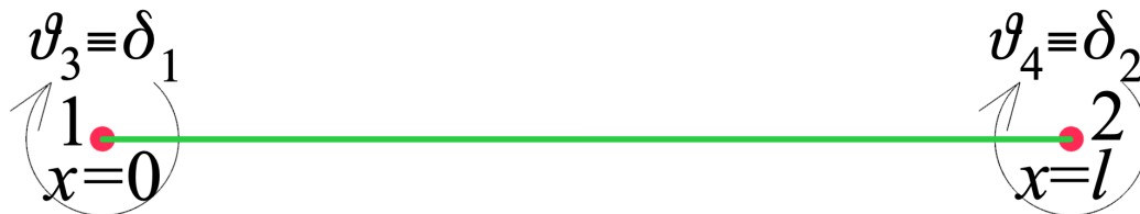
Obrázek 3.5: Natočení elementu od vlivu stříhacích sil v rovině \bar{xz} .
