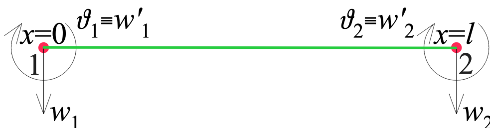
Obrázek 3.4: Posuvy a natočení elementu při ohybu v rovině \overline{xz} .
