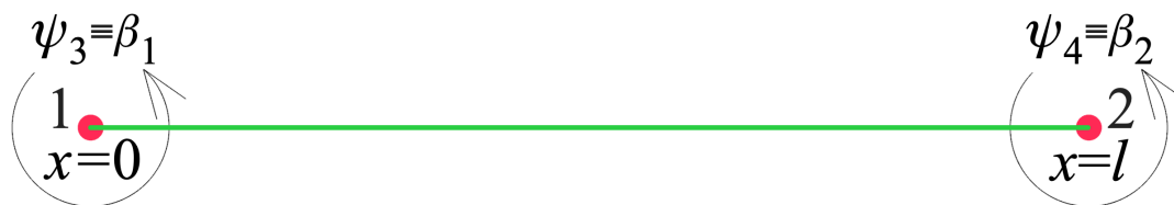
Obrázek 3.3: Natočení elementu od vlivu stříhacích sil v rovině \overline{xy} .
