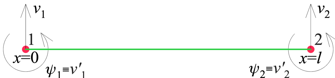
Obrázek 3.2: Posuvy a natočení elementu při ohybu v rovině \overline{xy} .
