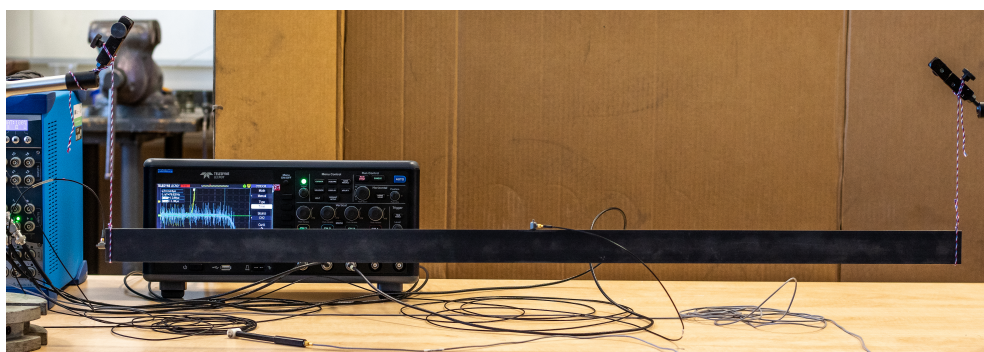
Obrázek 31: Konfigurace měření na ocelovém pásu
