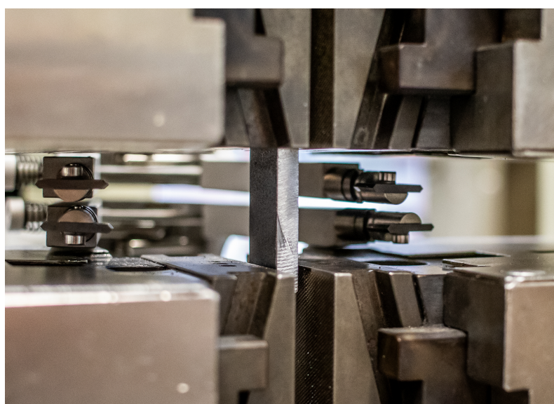
Obrázek 40: Příčný hliníkový vzorek připravený na tahovou zkoušku
