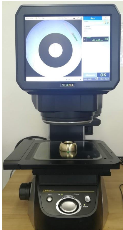
Obr. 3-5: Optický komparátor Keyence IM-7000
