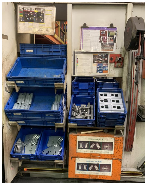
Obr. 3-6: Regály s válečkovým systémem pro posuv boxů, zdroj: vlastní zpracování
