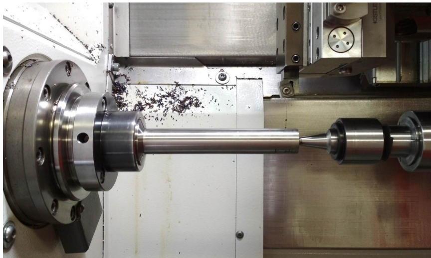
Obr. 16: Pohled do pracovního prostoru stroje při zkoušce obrobitelnosti oceli 42SiCr
