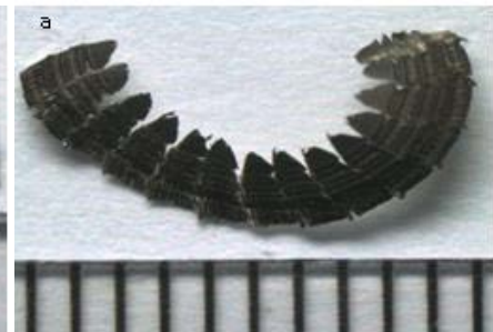
Obrázek 16 - Nesousledné čelní frézování [23]
