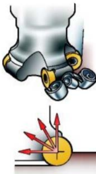
Obrázek 3 - Nastavení úhlu hlavního ostří [4]
