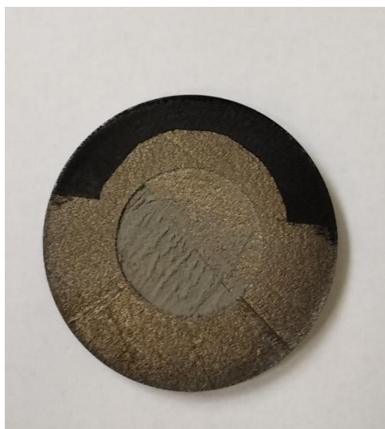
Obrázek 3.17 Model s nanesenou barvou a práškem
