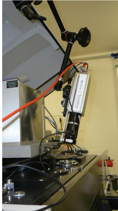
Obrázek 3.5 Termografická kamera umístěná nad průzorem do pracovního prostoru
