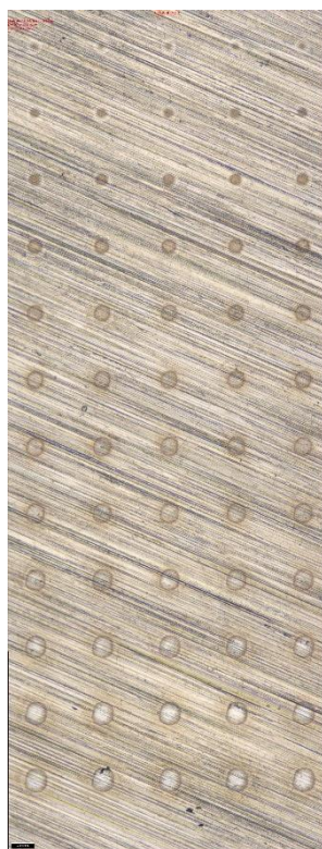
Obr. 29: Laserové stopy na povrchu oceli AISI 316L
