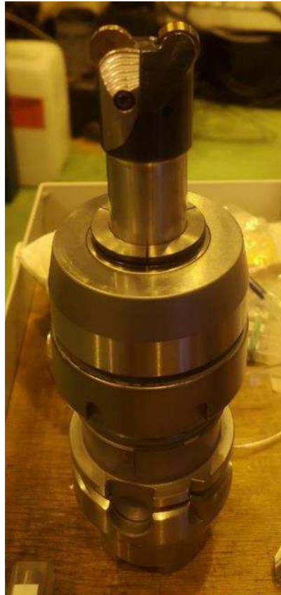
Obrázek 22 - Upnuté sklíčidlo s nosičem VBD a VBD LX11
