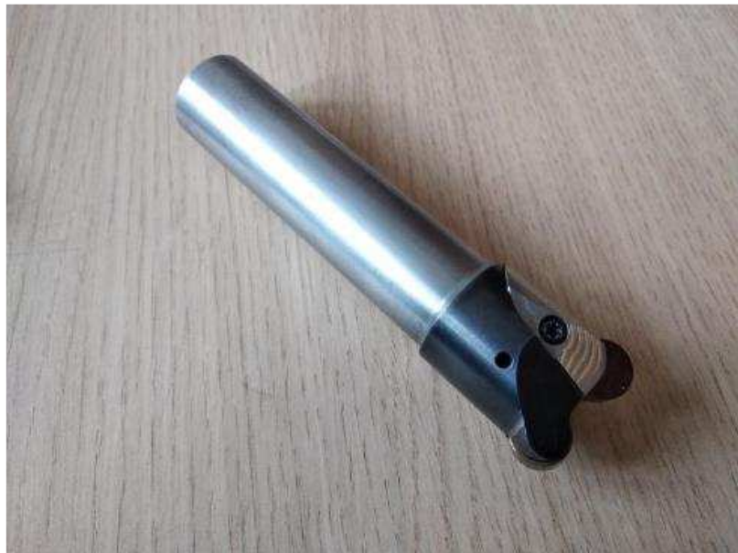
Obrázek 21 - Dvoubřítá fréza s břitovou destičkou LX11
