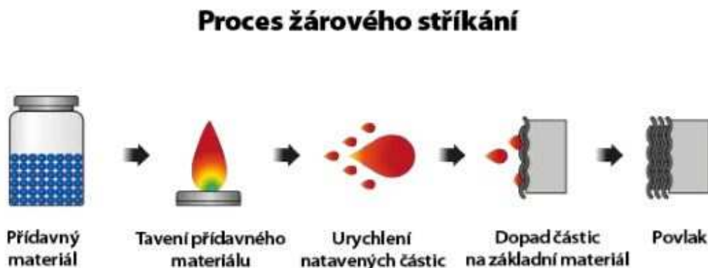
Obrázek 1 - Princip vytváření žárových nástřiků [1]
