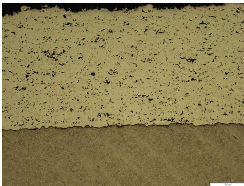
Obrázek 24 - Řez obrobku leptaný pod světelným mikroskopem 100x zvětšený
