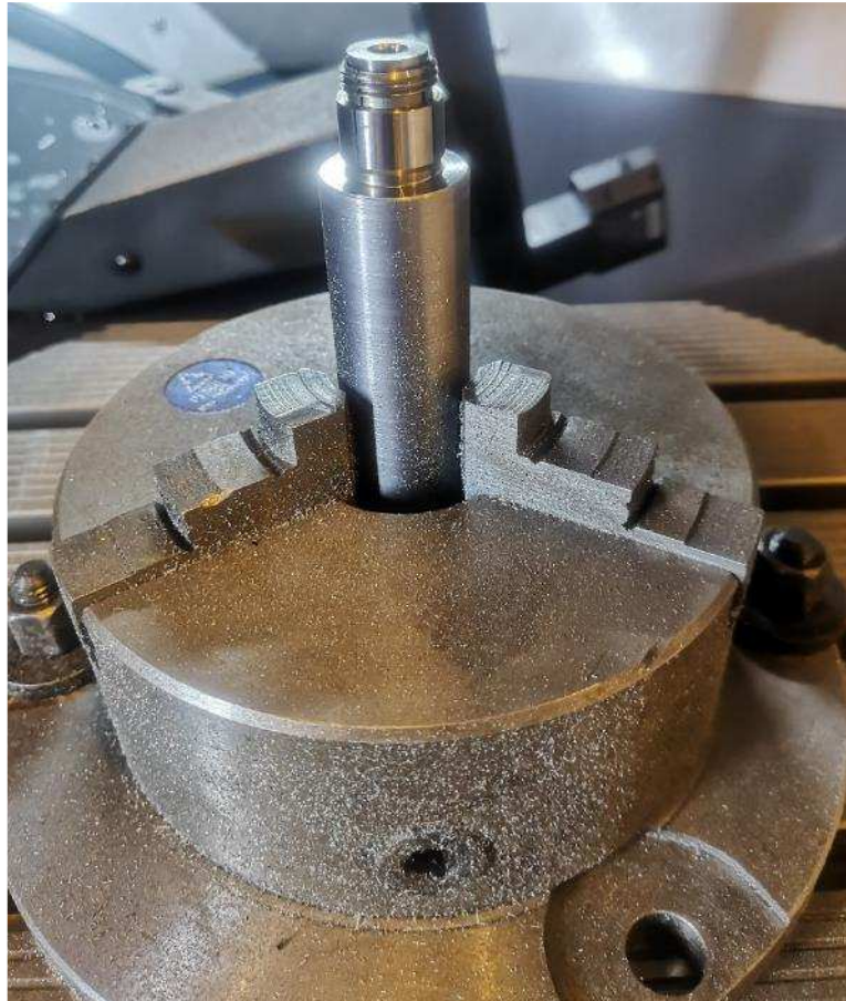
Obrázek 29 - Přípravek pro obrábění kulové plochy upnutý ve sklíčidle
