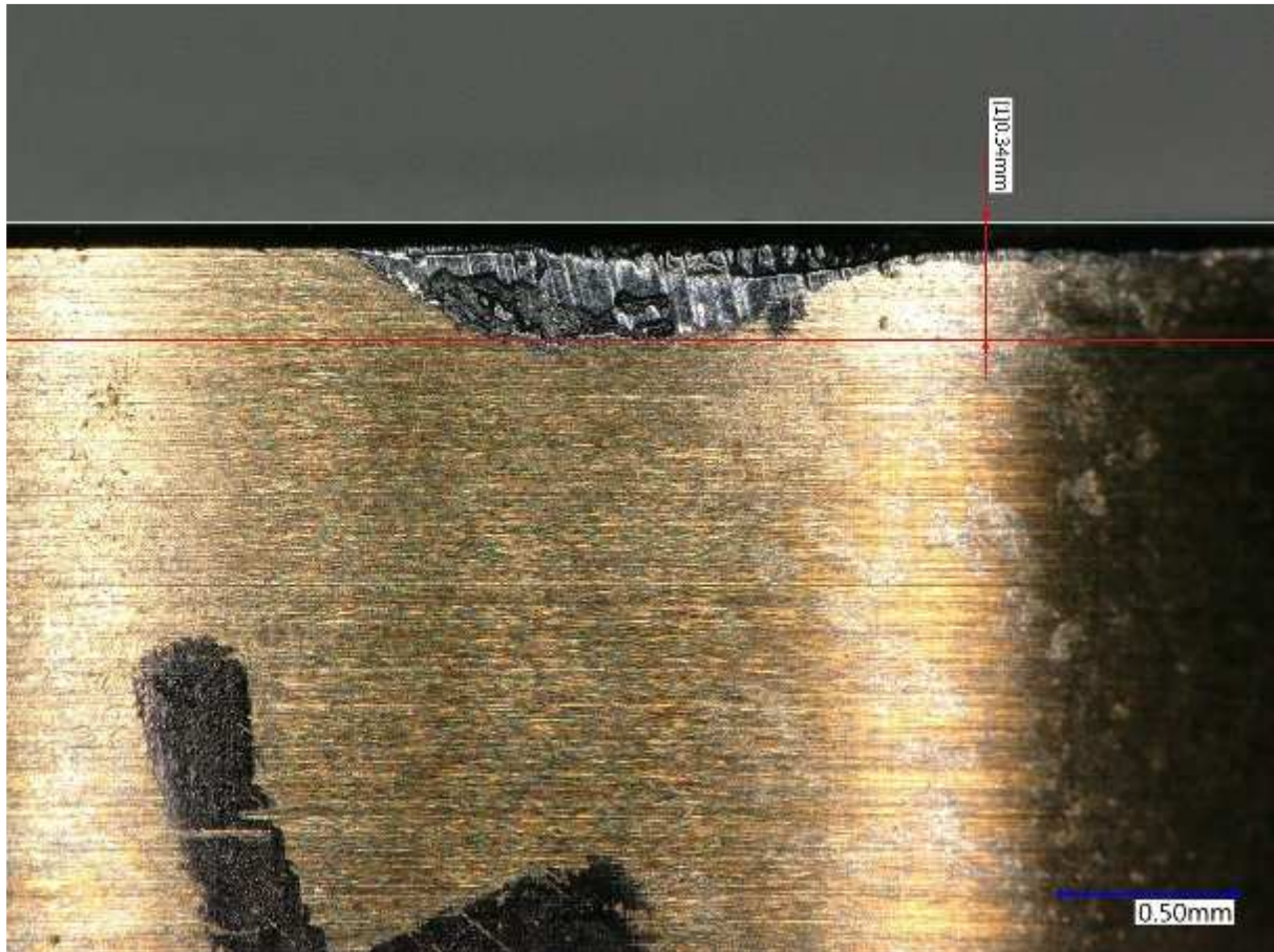
Obrázek 41 - Opotřebení na hřbetu VBD s odměřenou hodnotou opotřebení
