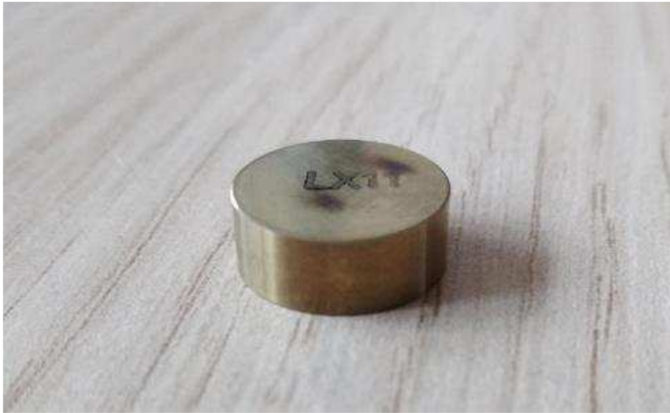
Obrázek 20 – Výměnná břitová destička RNGN 120400 LX11
