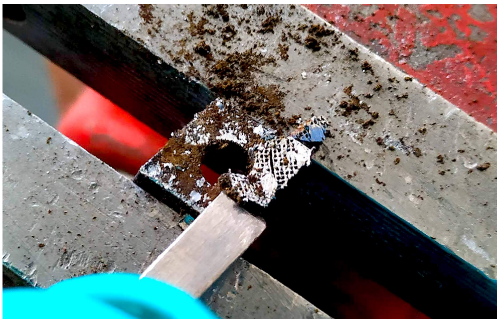
Obrázek 38 – Odstraňování podpůrných struktur na VBD pomocí sekáče
