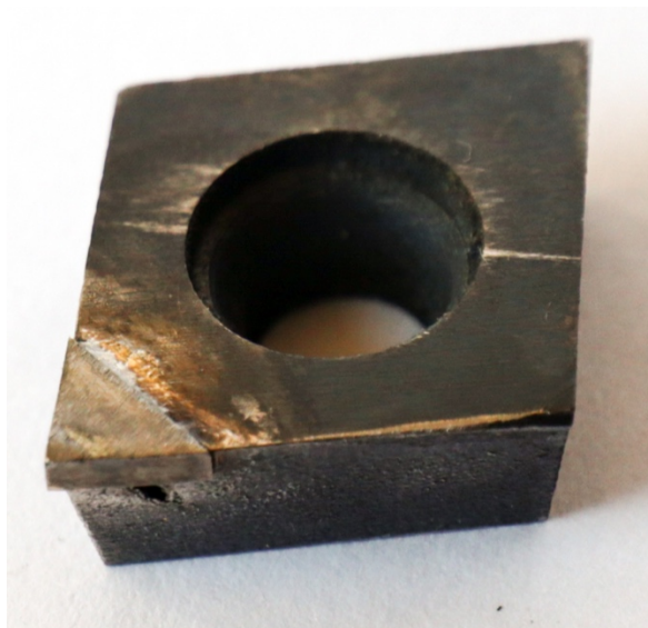
Obrázek 78 – Variant B s připájeným břitem ze slinutého karbidu
