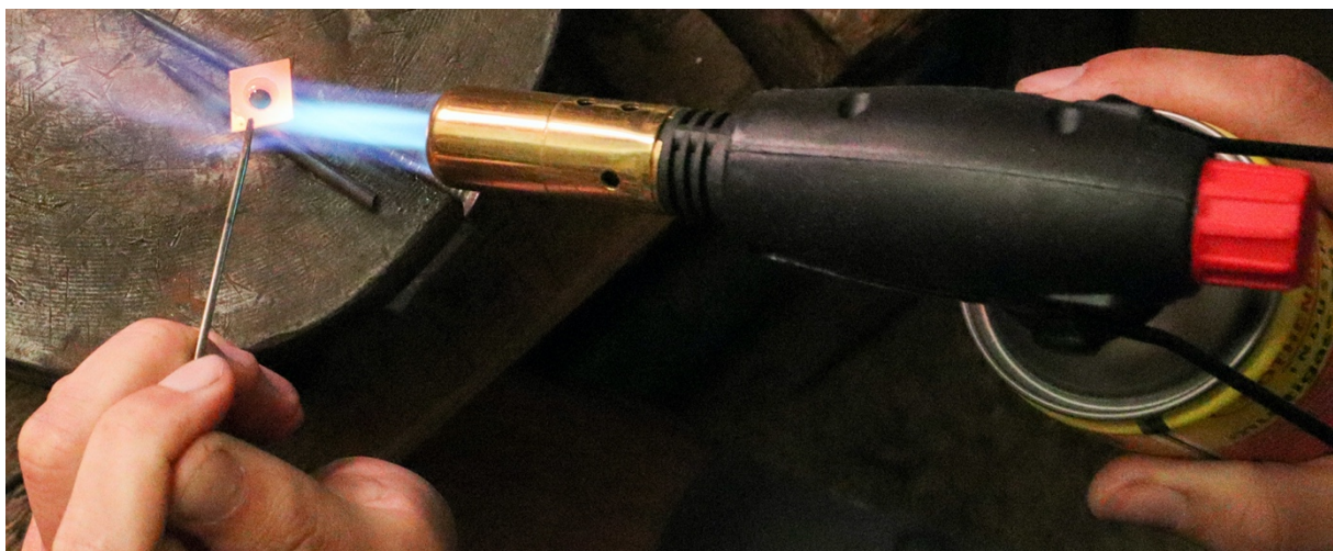
Obrázek 77 – Proces pájení břitu ze slitutého karbidu
