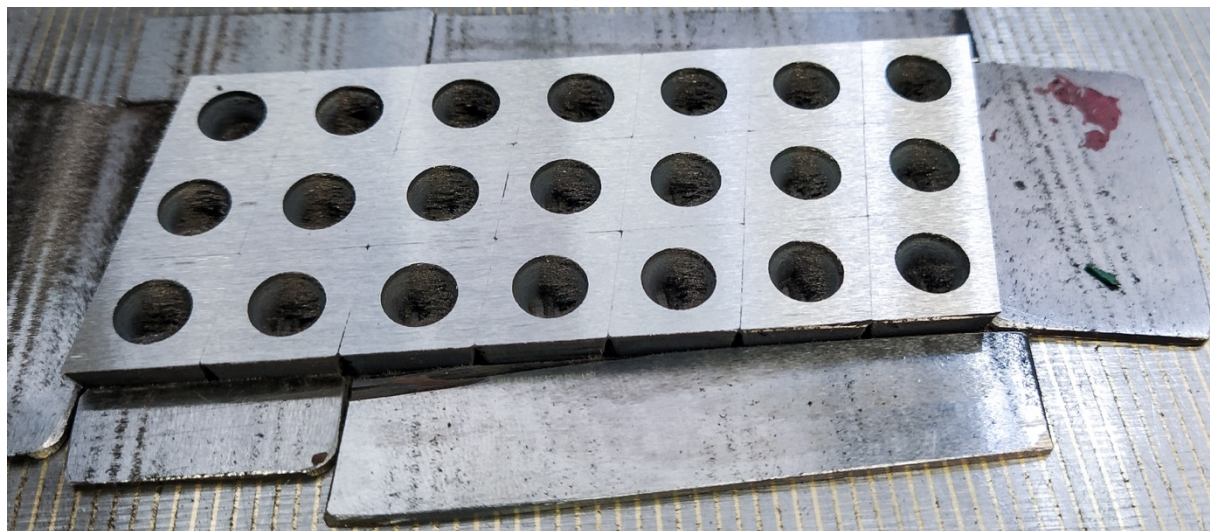
Obrázek 68 – Obroušená čela VBD (varianta E)
