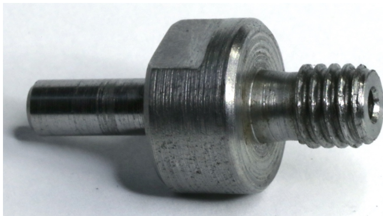
Obrázek 39 – Finální podoba spojky CPR-ND
