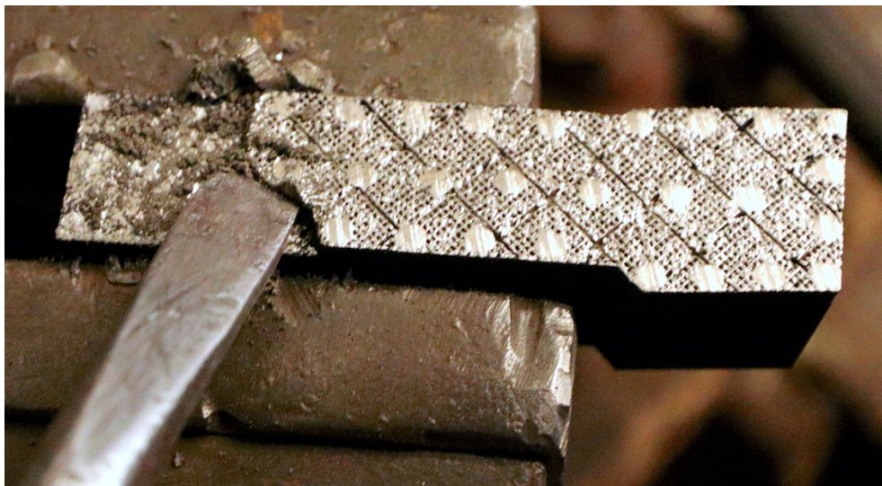
Obrázek 65 – Odstraňování podpůrných struktur z nožového držáku
