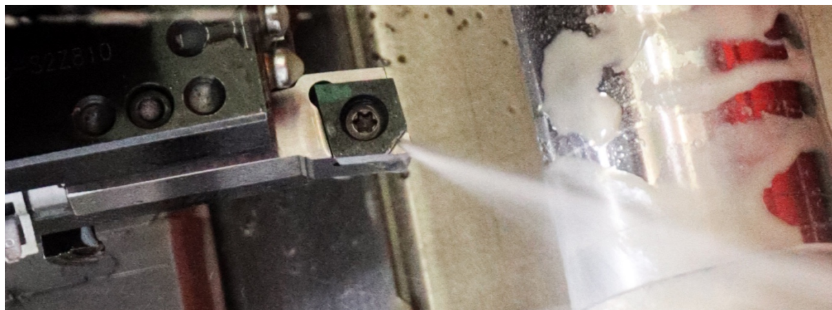
Obrázek 92 – VBD varianty E při spuštěném chlazení
