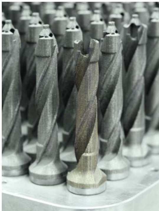
Obrázek 13 – Aditivně vyrobená těla QTD vrtáků [16]
