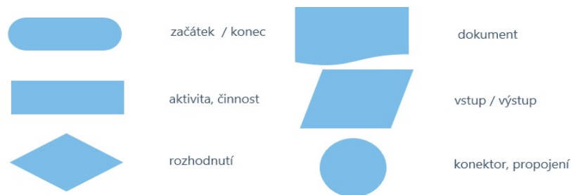
Obrázek 2 - základní prvky vývojového diagramu. Převzato z [9]
