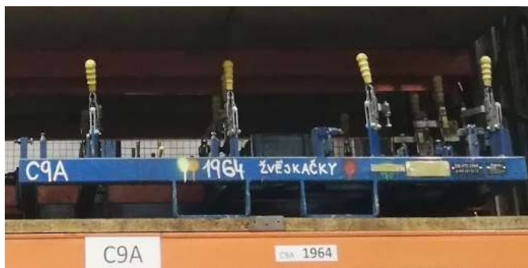
Obrázek 25 - Přípravek uzpůsobený pro přepravu VZV
