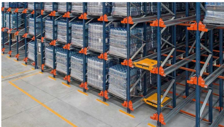
Obrázek 10 - Kanálový skladový systém – Shuttle [19]
