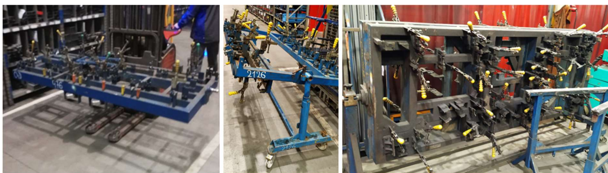
Obrázek 21 - Malé (vlevo), střední (uprostřed) a velké (vpravo) svařovací přípravky
