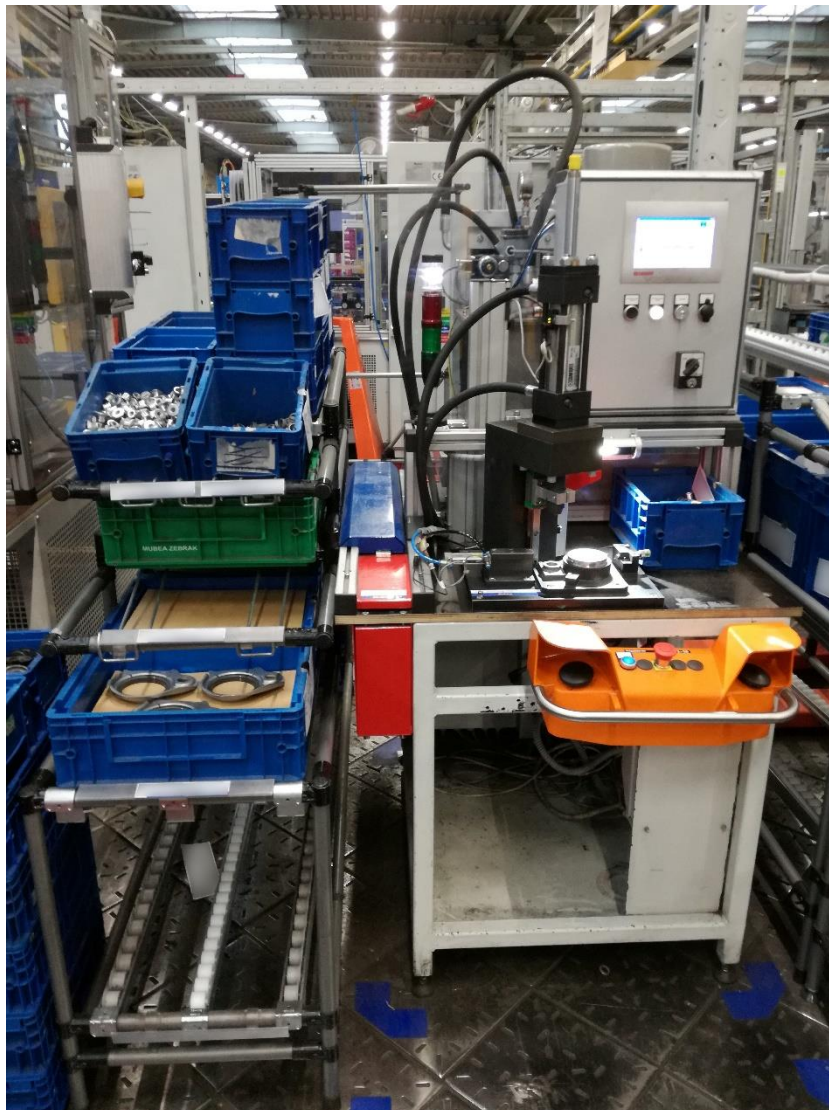
Obrázek 26 První montážní stanoviště (AP1) linky DAT2
