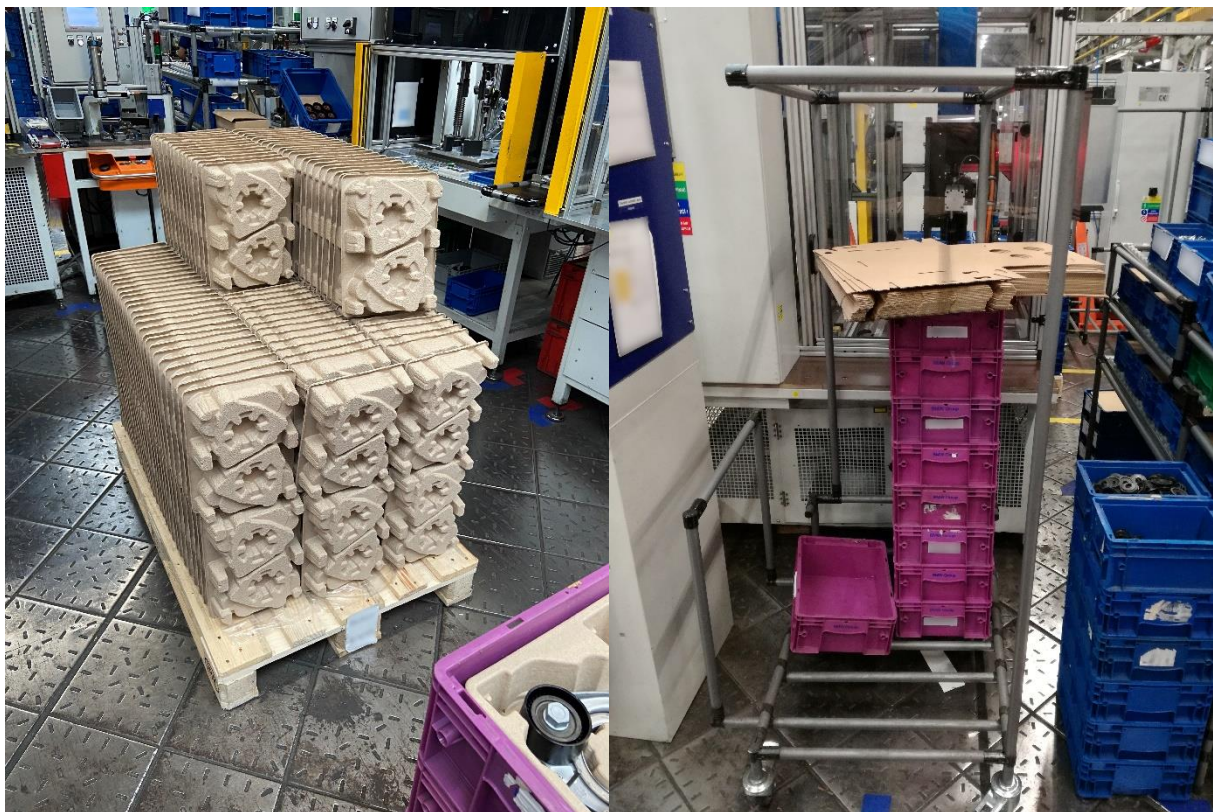
Obrázek 44 Způsob skladování nového typu balící kartonáže (vlevo) a starého typu (vpravo) na lince DAT2
