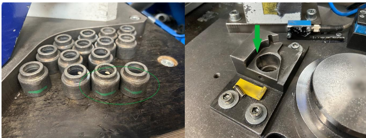
Obrázek 40 Barevné značení distančního pouzdra na AP5 (vlevo), označení místa umístění na přípravku (vpravo)
