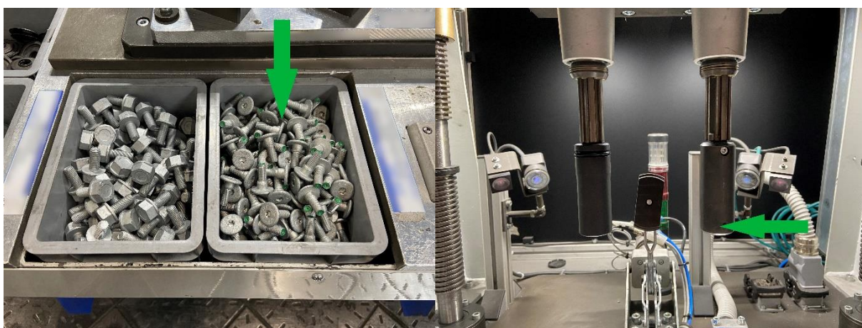
Obrázek 41 Barevné značení šroubů na AP6 (vlevo), označení místa umístění na přípravku (vpravo)
