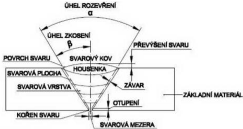
Obrázek 3.1 - Ukázka tupého svaru [10]
