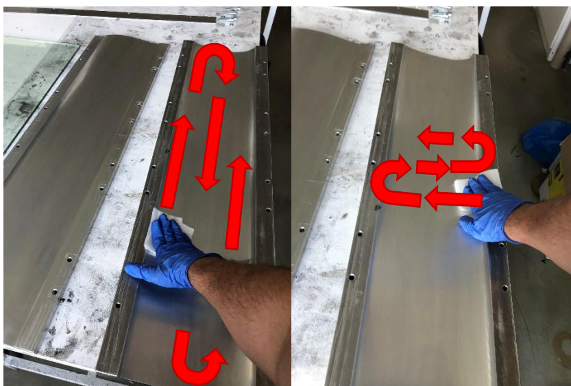
Obrázek 4 - Nanášení separátoru podélný směr (vlevo), příčný směr (vpravo)
