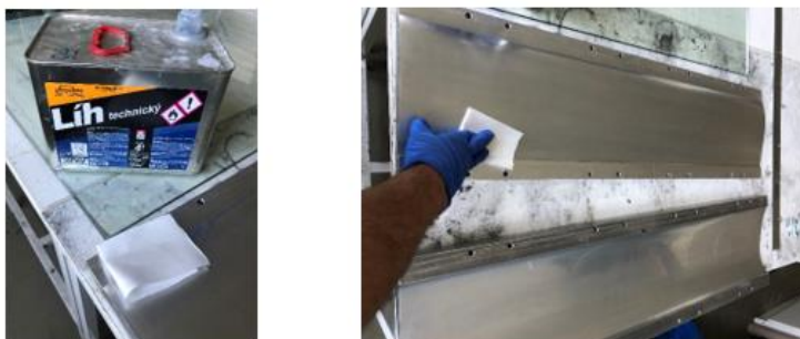
Obrázek 1 - První krok čištění - líh, speciální ubrousek (vlevo), čištění formy (vpravo)
