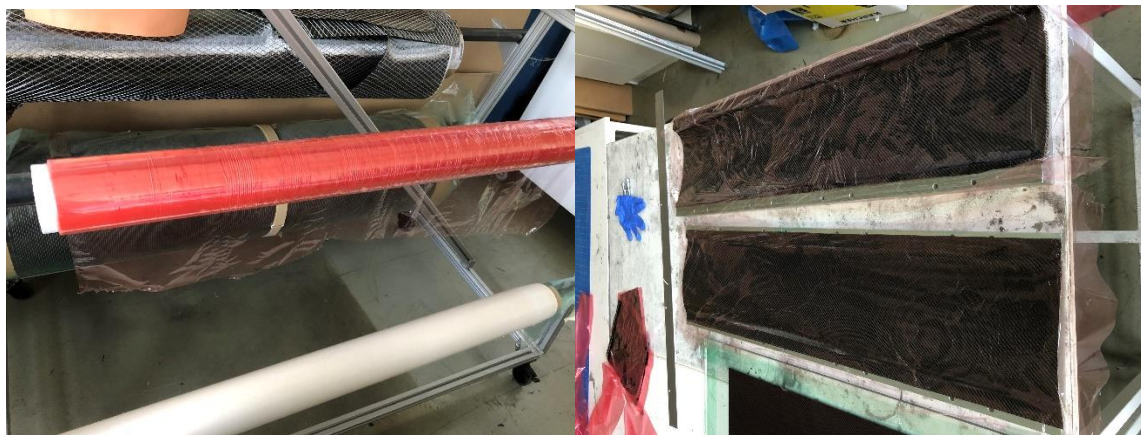
Obrázek 11 - Polopropustná fólie (vlevo), fólie položená na díly (vpravo)
