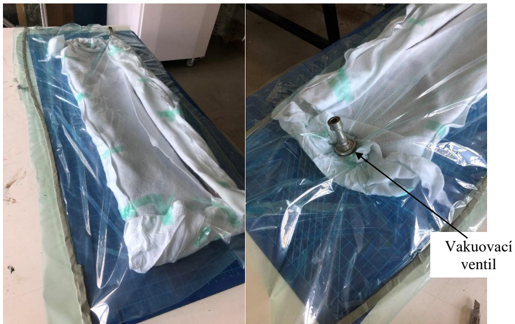
Obrázek 15 - Díl připravený ke vložení do autoclavu, vaukovací ventil (vpravo)
