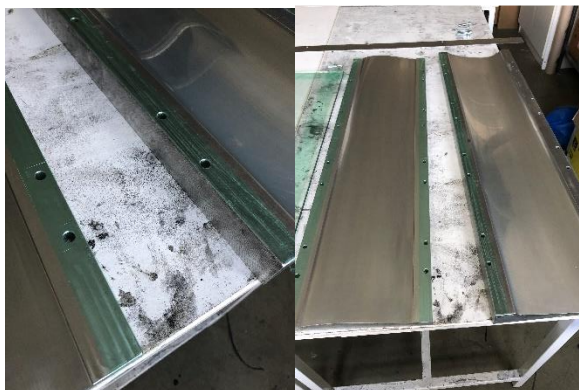
Obrázek 5 - Zalepení nepotřebných děr
