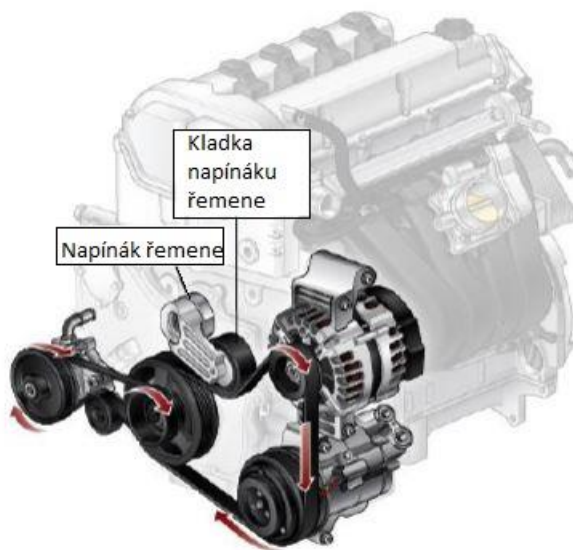
Obrázek 3 - Napínák řemene připevněn k motoru [4]
