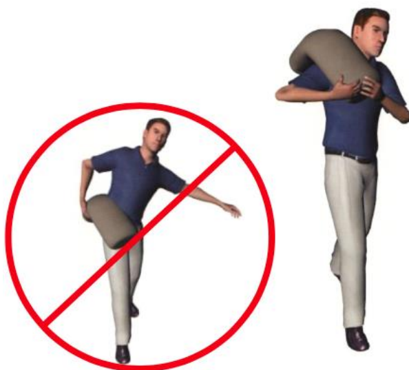
Obrázek 3-3: Symetrické zatížení od břemene [11]
