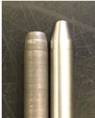
Obr. 55 Nový tvar trnu vozíku (vpravo) versus starý tvar (vlevo) [28]
