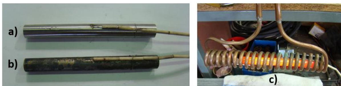
Obr. 13 a): vzorek před zušlechťením, b): vzorek po zušlechťení, c): austenitizace v indukční cívice
