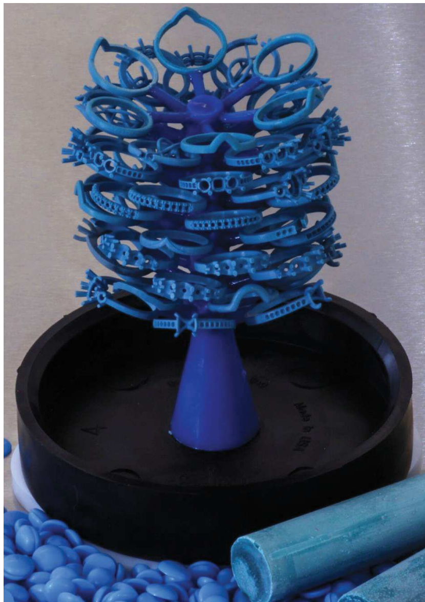
Obr. 30: Stromeček modelů prstenů vyrobený technologií DoD [51]
