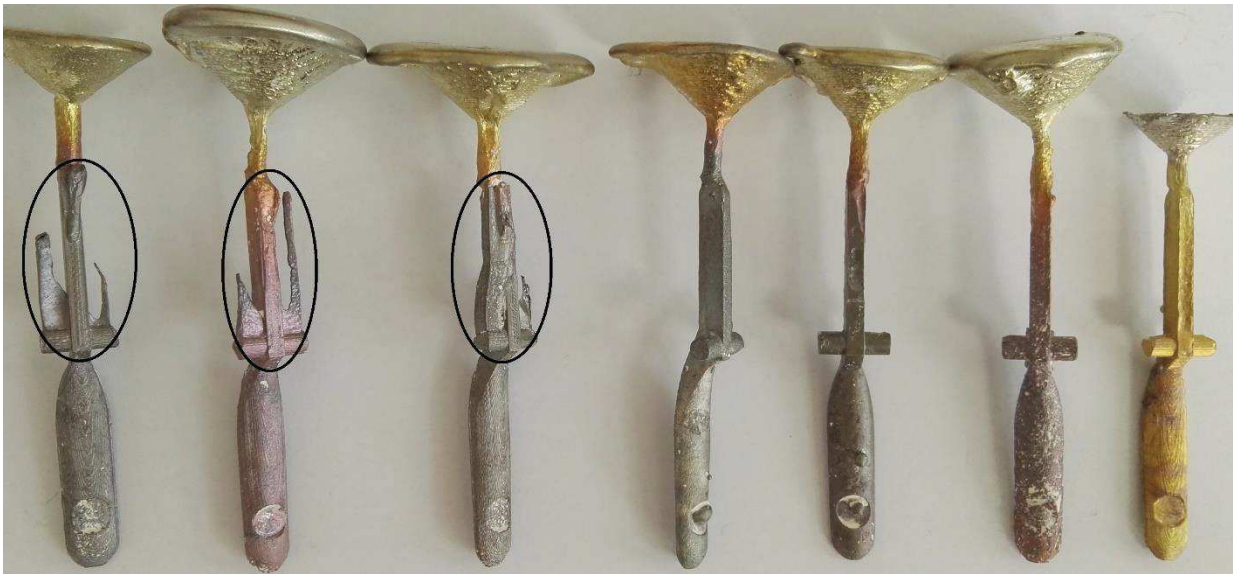
Obr. 50: Odlitky z první série, u prvních tří označena místa defektů
