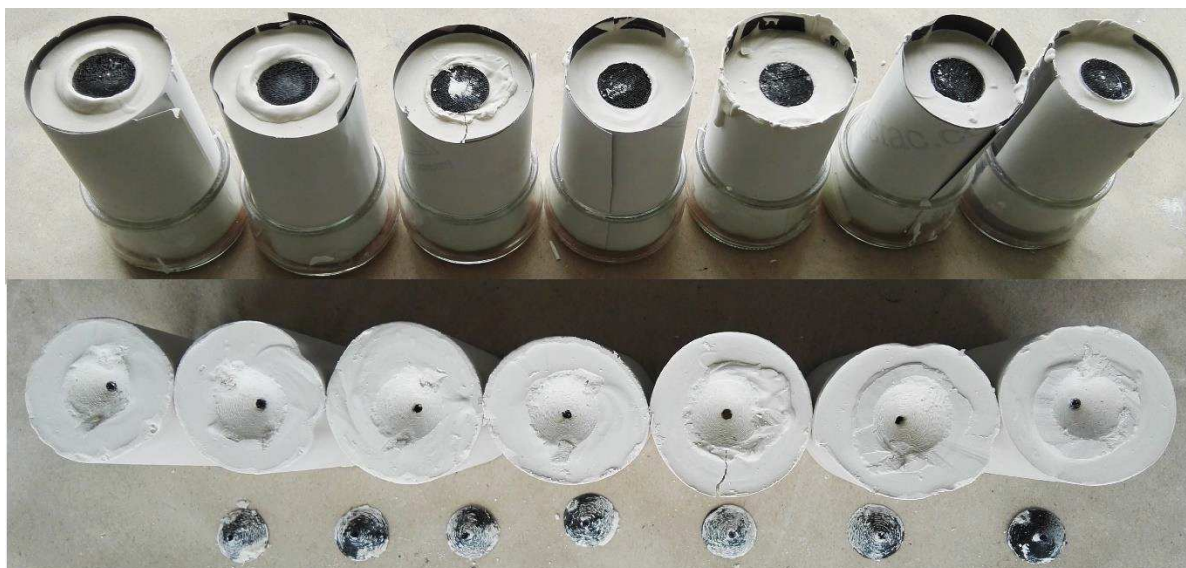
Obr. 46: Sádra ve formách (nahore) sádrové formy po odstranění vtokové soustavy (dole)
