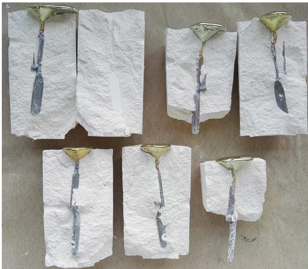
Obr. 49: „Rozpůlené“ sádrové formy s odlitky
