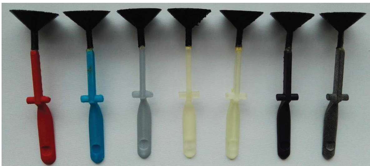
Obr. 45: Modely „klapky 2“ s vtokovou soustavou (první série)
