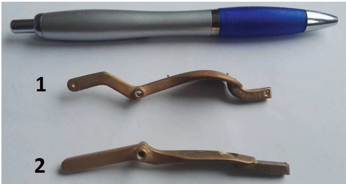
Obr. 31: Bronzové odlitky klapek (stav po slévárně)
