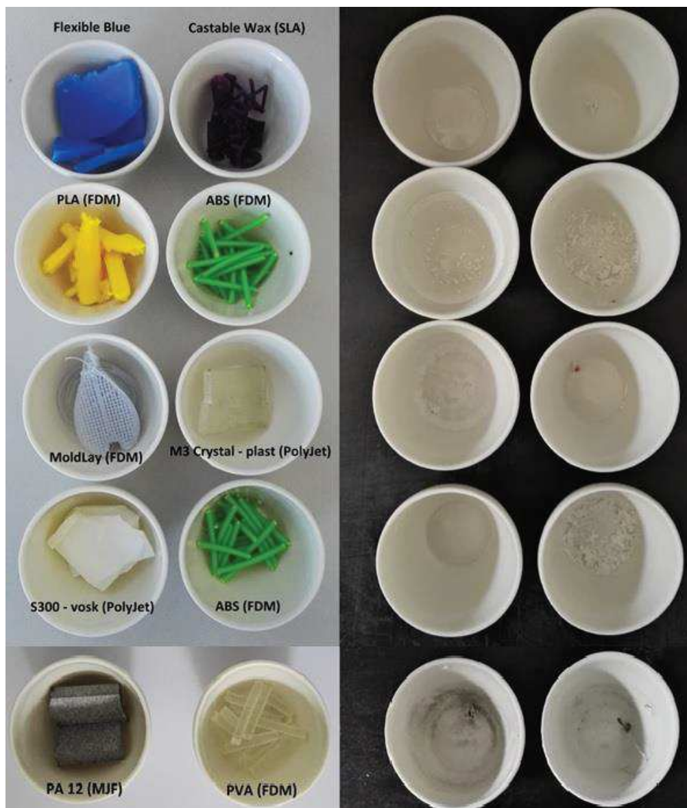
Obr. 37: Navážka před a po spálení (vpravo ve stejném pořadí)
