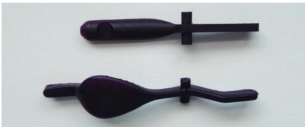
Obr. 42: Klapky z CastableWax z tiskárny Original Prusa SL1
