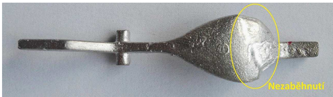
Obr. 56: Klapka z M3 Crystal z tiskárny ProJet 3510 HD
