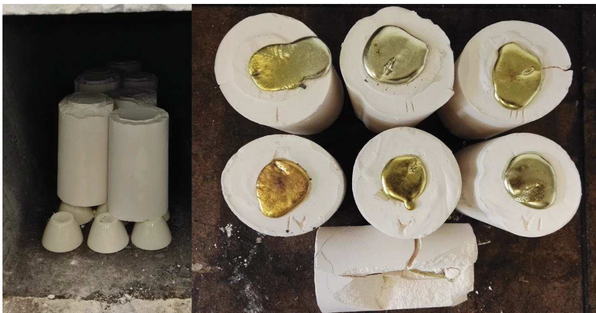
Obr. 47: Umístění forem na kelímcích v peci (vlevo), formy po odlití (vpravo)
