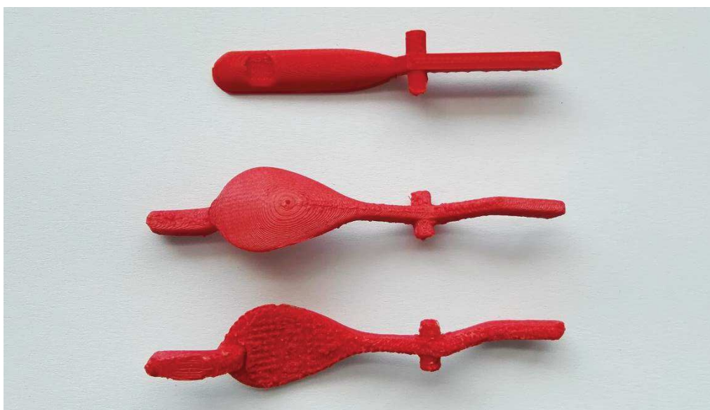
Obr. 38: Klapky z PLA z tiskárny Geetech A10M
