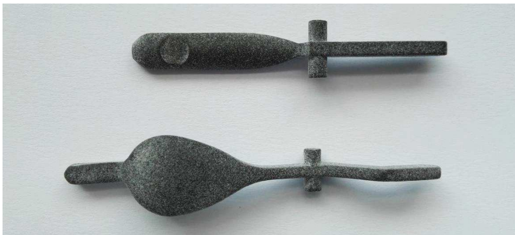
Obr. 44: Klapky z PA 12 z tiskárny HP Jet Fusion 4200
