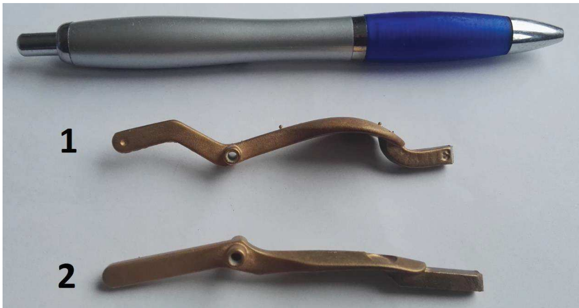
Obr. 15: Bronzové odlitky klapek (stav po slévárně)
