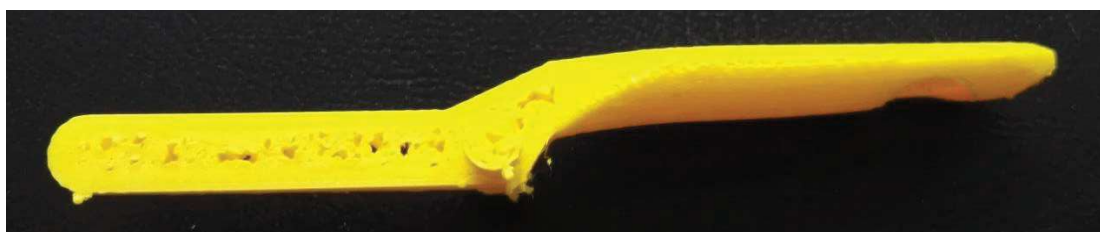
Obr. 36: Detail povrchových děr (model je průhledný)
