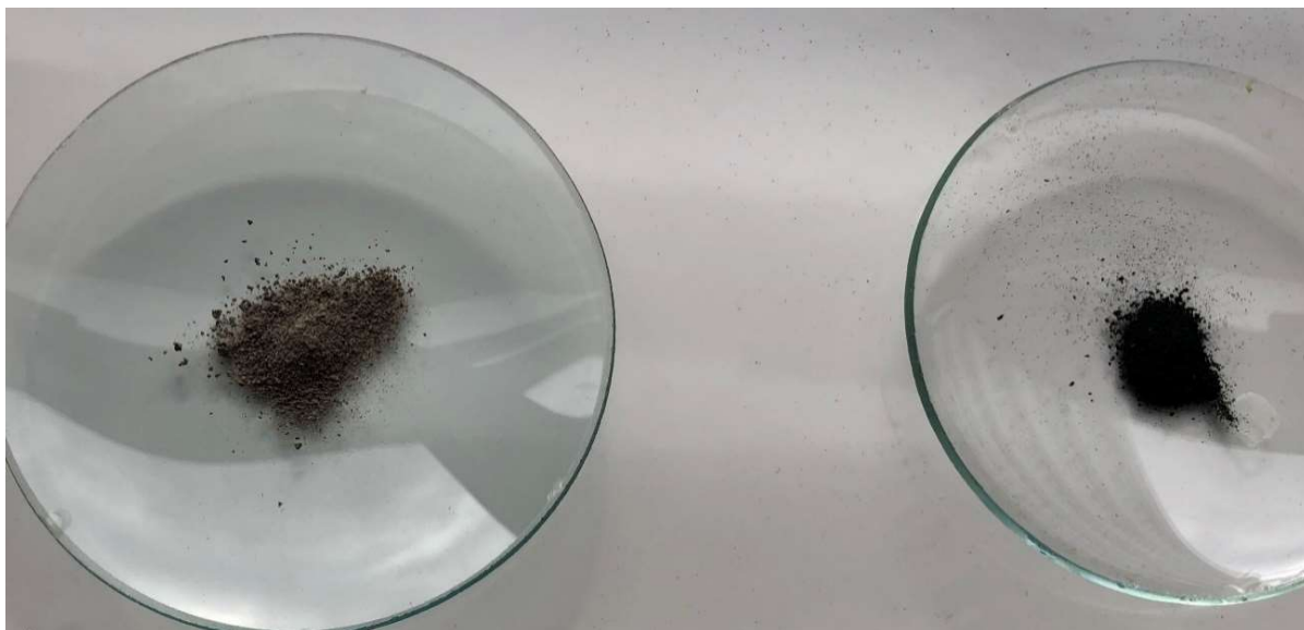
Obrázek 29 Změna barvy vzorku aktivovaného Na_2CO_3 po aktivaci (šedá) a po výpalu (černá)
