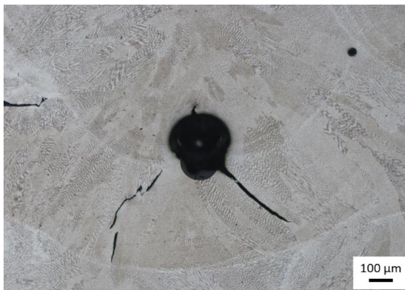
Obr. 33: Trhliny a vměstky u Součásti 8, zvětšení 50x
