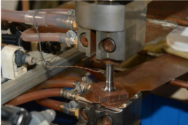
Obrázek 32 - Tepelné zpracování materiálu T20 pomocí simulátoru MTS. Na snímku je vidět přivařený termočlánek ke kontrole teploty.
