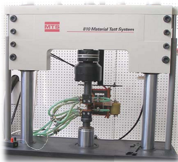
Obr. 5.3: Tepelně – mechanický simulátor MTS
