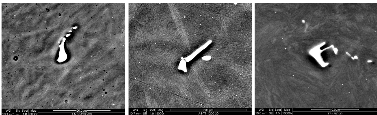
Obr. 5.31, 5.32, 5.33 – Tavba T4 a T7 – teplota austenitizace zleva 2x 1200 °C a vpravo 1250 °C
