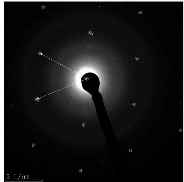
Obr. 5.54, 5.55: B4 – T4 – 125 - Svítící jemné precipitáty niobu NbC vlevo a difraktogram vpravo
