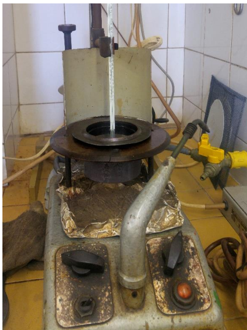
Obr. 75 Zařízení na měření bodů vzplanutí, resp. hoření
