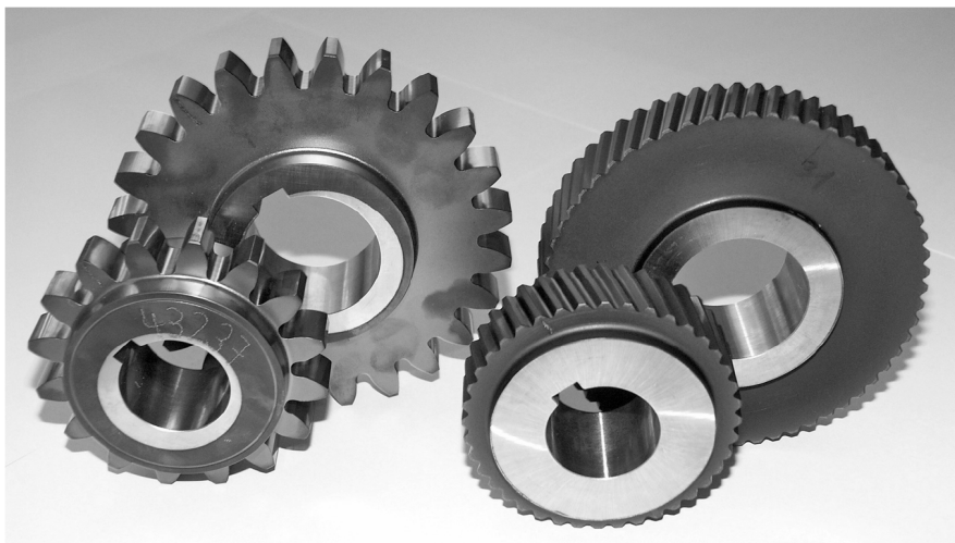
Obrázek 22: Optimalizace geometrie ke snížení ztrát v ozubení [7]
