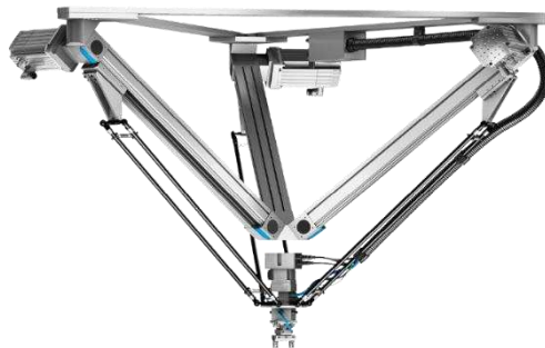
Obrázek 21 – Paralelní kinematická struktura (tripod) [30]
