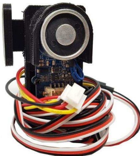
Obrázek 15 - Open source robotické rameno Niryo One - elektromagnet [22]
