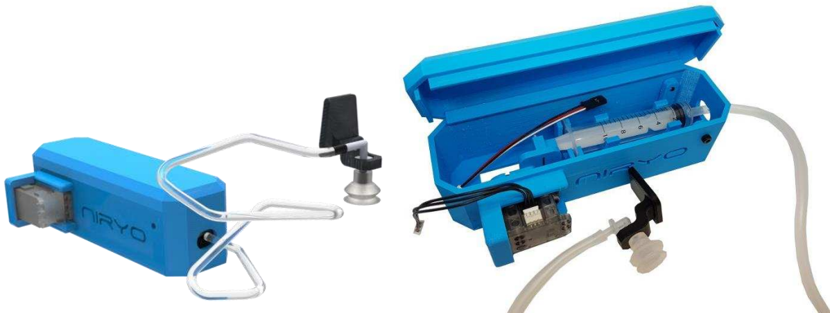
Obrázek 14 - Open source robotické rameno Niryo One - vakuová pumpa [20] [21]
