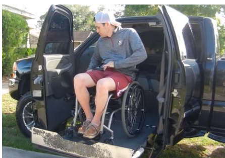
Obrázek 10 Řešení výstupu vozíčkáře z vozidla [9]
