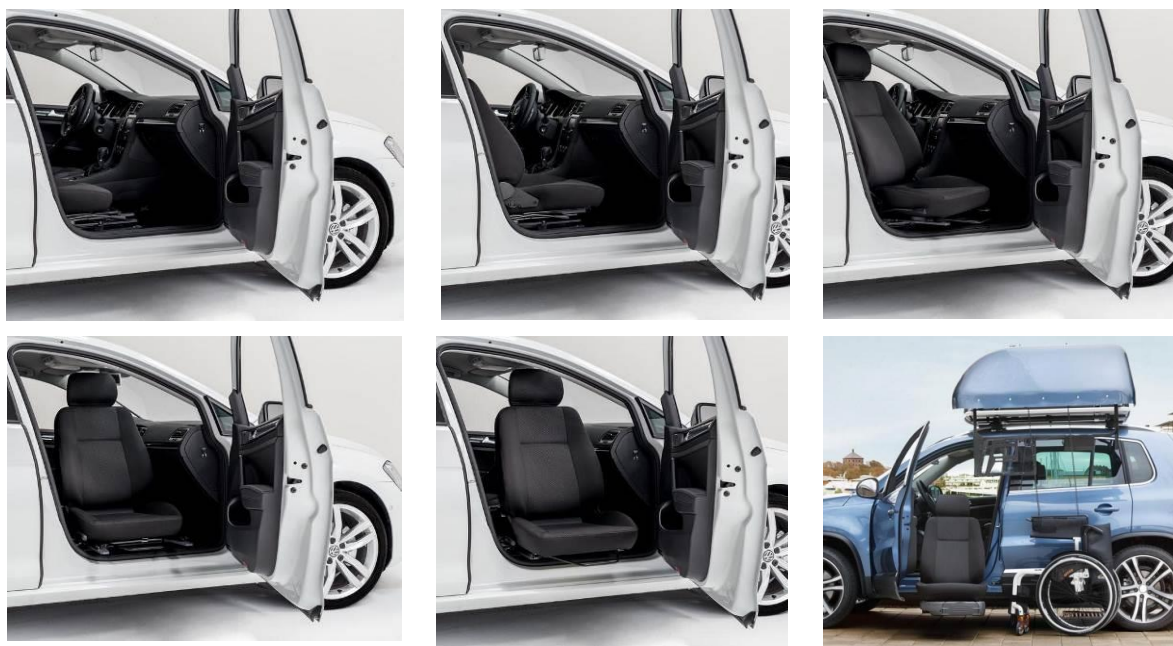
Obrázek 12 Otočné sedadlo Turnout [11]
