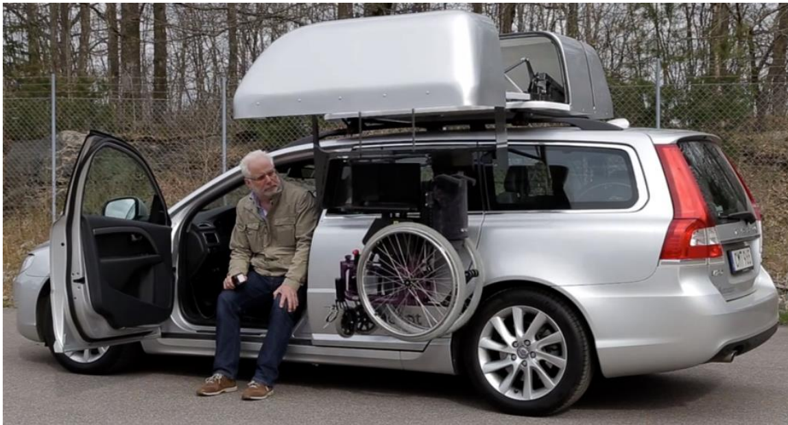
Obrázek 15 Nakládání invalidního vozíku na střechu automobilu [14]
