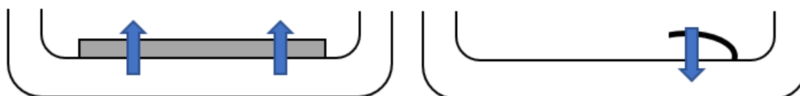
Obrázek 29 - Tvarová pojistná a páková brzda na madle kočárku s vyznačeným směrem regulace brždění
