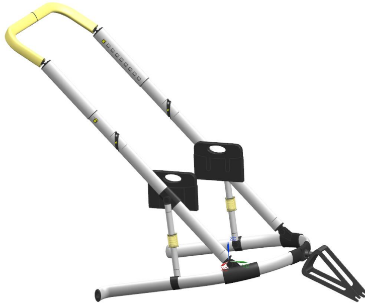
Obrázek 45 - Zjednodušený model pro MKP
