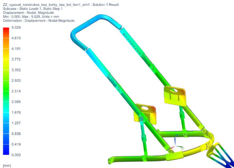
Obrázek 48 - Posunutí dle MKP
