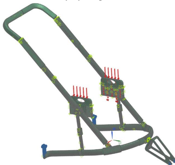
Obrázek 47 - Kompletní podklad pro MKP výpočet
