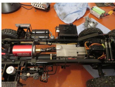
Obrázek 53 Model Tatra s celokovovou převodovkou Josefa Dojčara
