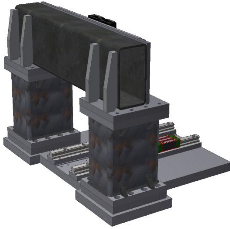
Obrázek 84 Vyztužení pomocí žeber
