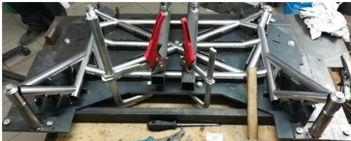
Obr. 72 - Zapřípravkování přední nápravnice
