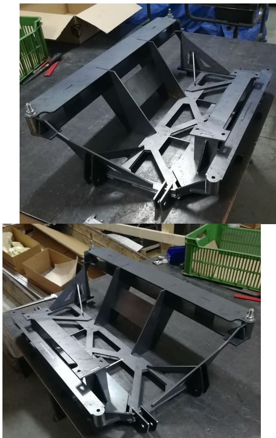
Obr. 70 - Falešná nápravnice včetně svrtávacího přípravku
