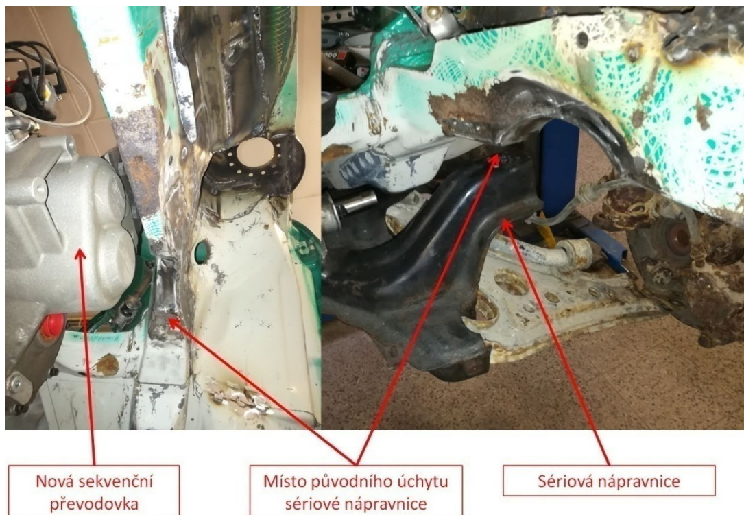
Obr. 31 - Kolizní oblast nové převodovky se sériovou nápravnicí
