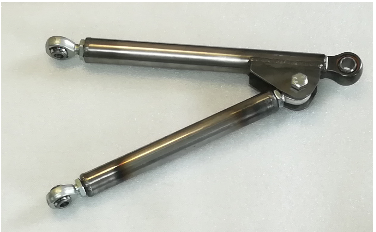
Obr. 80 - Svařené kyvné rameno
