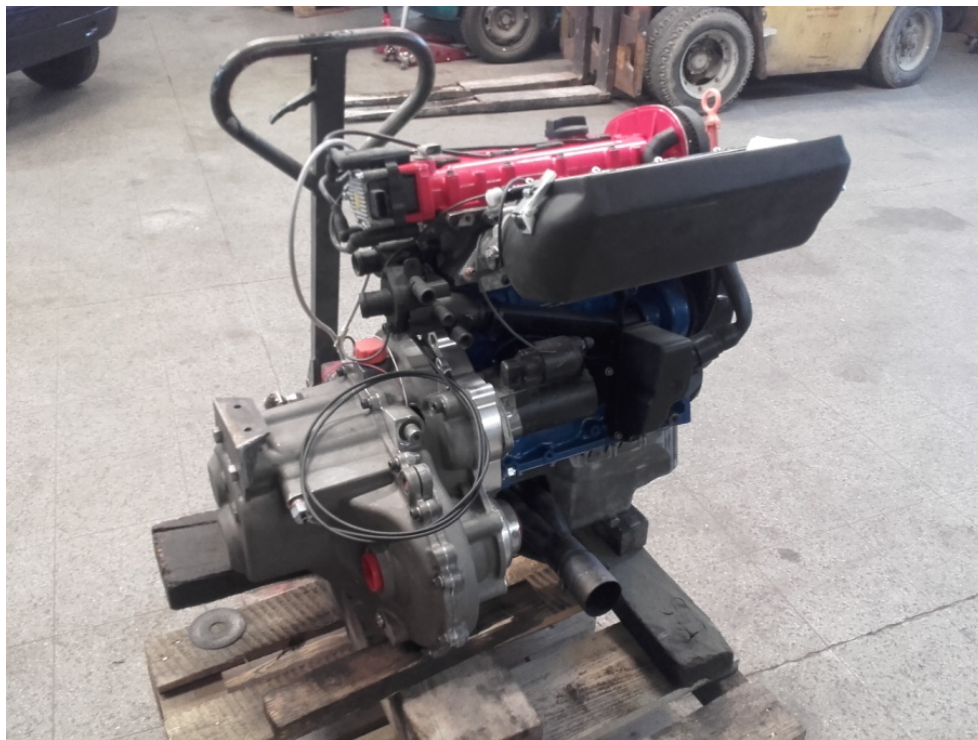
Obr. 29 - Nový agregát se sekvenční převodovkou
