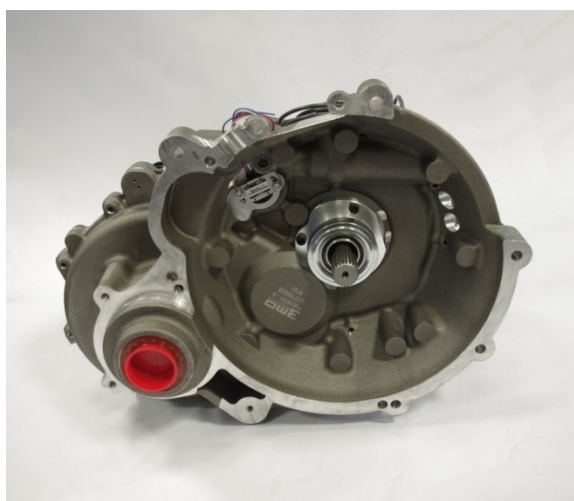
Obr. 33 – Sekvenční převodovka 3MO LC776 – EVO [37]
