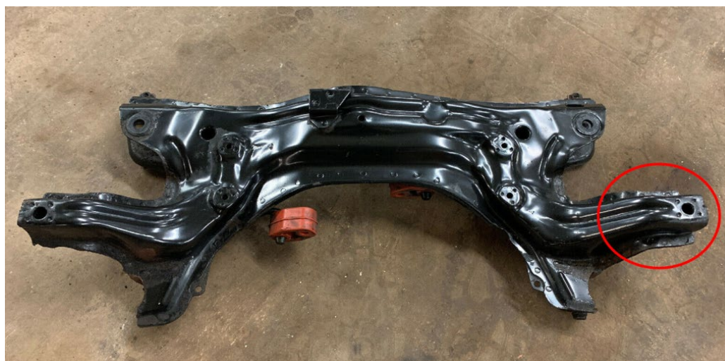
Obr. 30 - Sériová nápravnice s označením místa kolize
