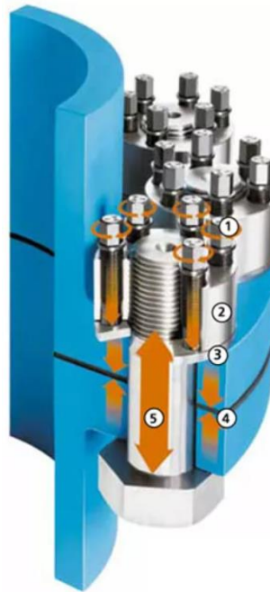
Obrázek 3-12 Princip přepínacího systému SUPERBOLT (ТРИСТАБИВЕСТ, 2020).
