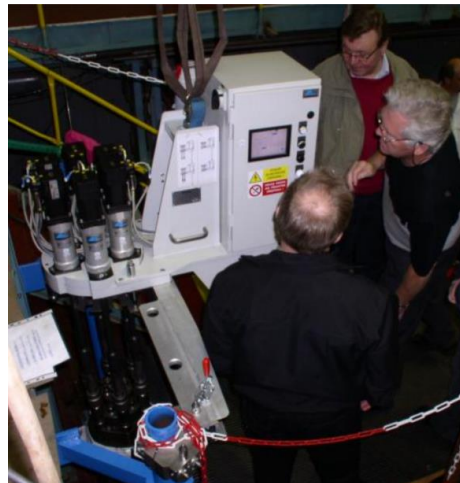
Obrázek 3-14 Utahovací jednotka EZ-650 TK-KNI ŠKODA JS a.s. (Ruchař, 2010).
