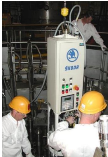
Obrázek 3-13 Utahovací jednotka EZ-650 ŠKODA JS a.s. (Ruchař, 2010).
