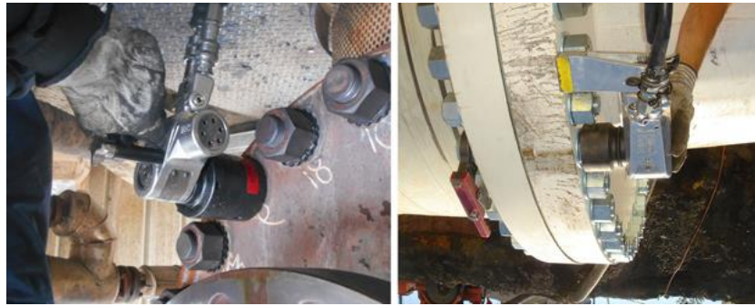
Obrázek 3-5 Hydraulický momentový klíč s výstupním čtyřhranem (Автомеханика, 2020).
