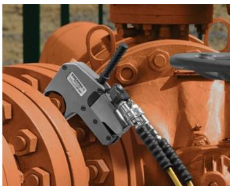
Obrázek 3-1 Nízkoprofilový hydraulický klíč kazetového typu (Автомеханика, 2020).
