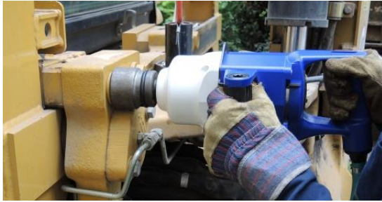
Obrázek 3-10 Pneumatický přímý rázový utahovák firmy DEPRAG (DEPRAG, 2020).
