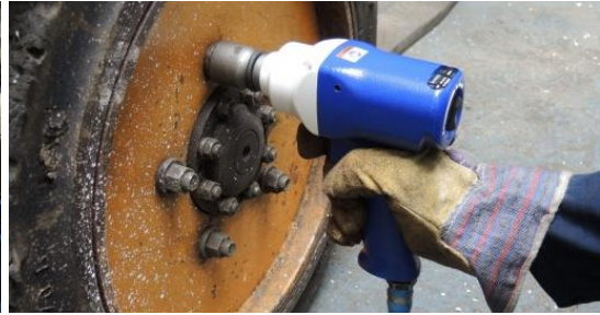
Obrázek 3-11 Pistolový rázový utahovák firmy DEPRAG (DEPRAG, 2020).
