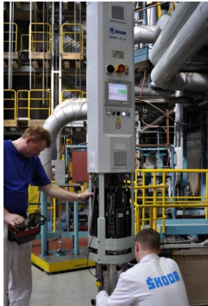
Obrázek 3-15 Utahovací jednotka EZ-250 ŠKODA JS a.s. (Ruchař, 2010).
