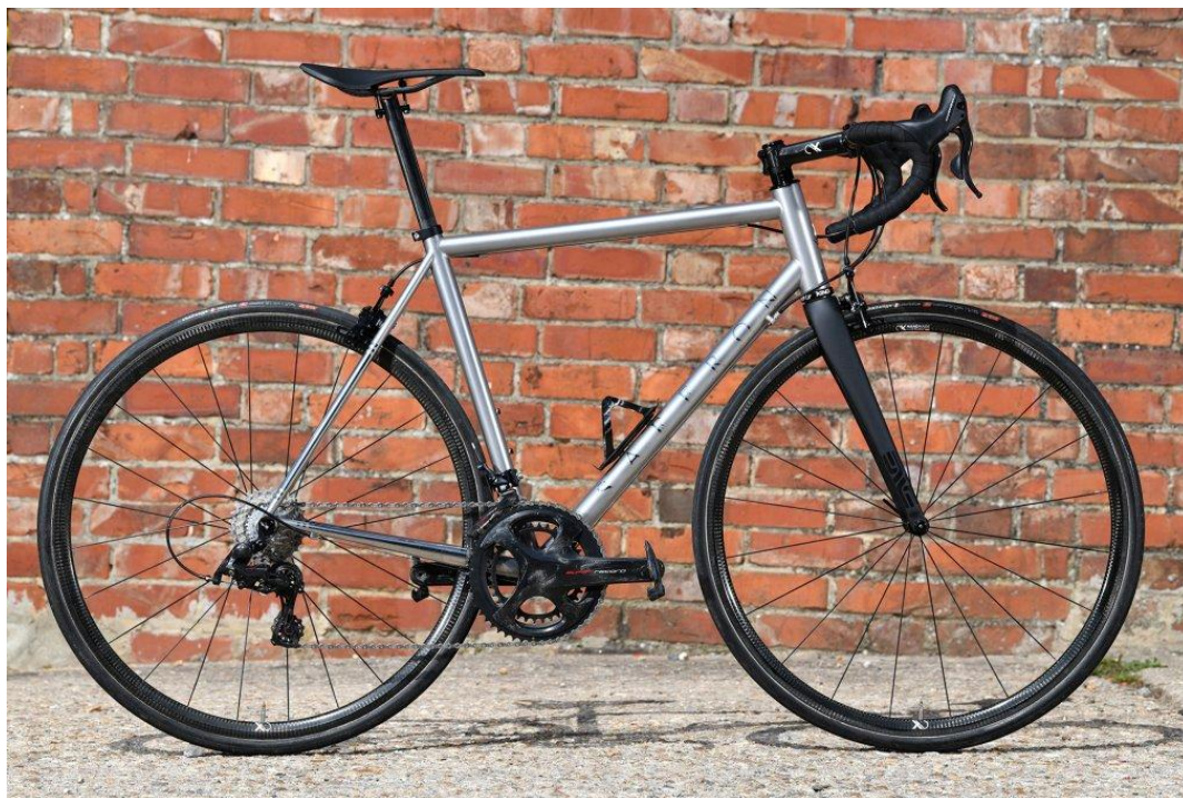
Obrázek 21: Lehké závodní ocelové kolo Saffron Naked Columbus XCr [21]
