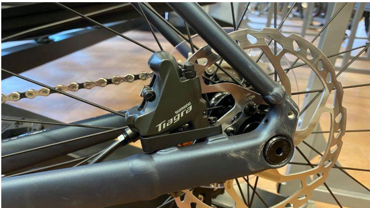
Obrázek 40: Uchycení brzdového třmenu na kole
