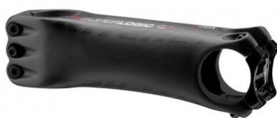
Obrázek 14: Představec Ritchey Superlogic Carbon [15]
