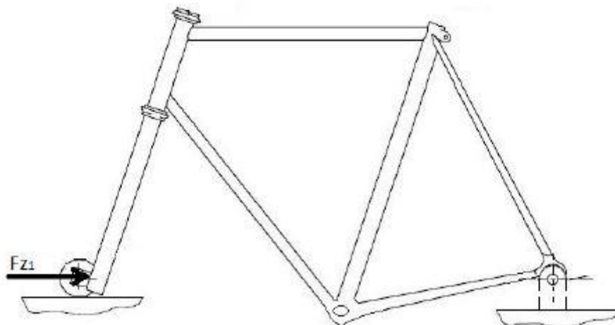
Obrázek 57: Zatěžovací stav při brzdění [1]
