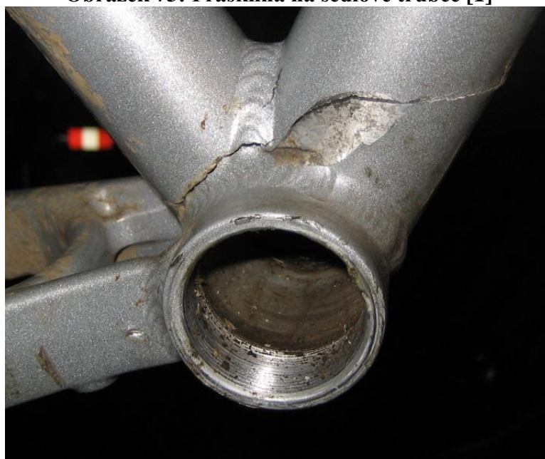
Obrázek 74: Prasklina na sedlové a dolní rámové trubce [1]
