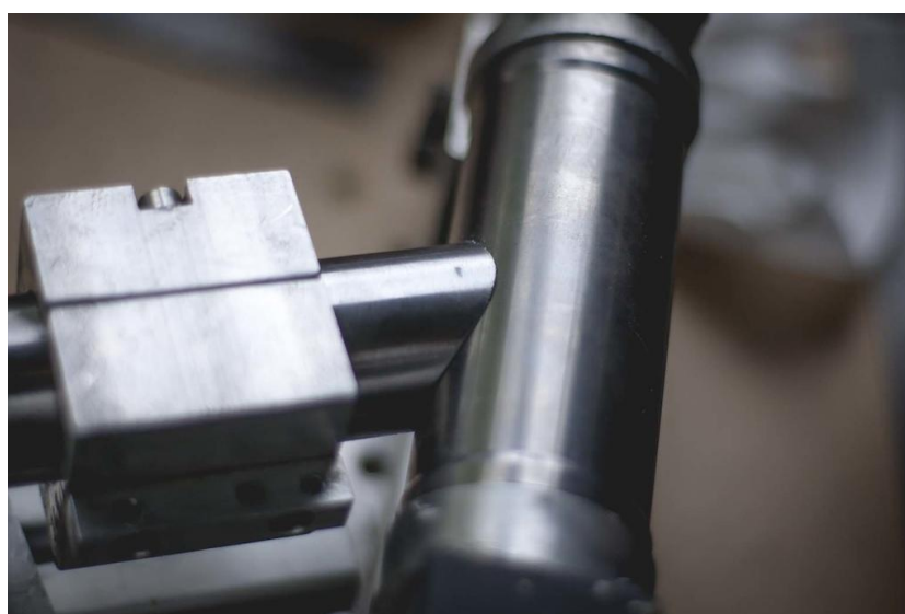
Obrázek 35: Ustavení trubek do požadované polohy [27]
