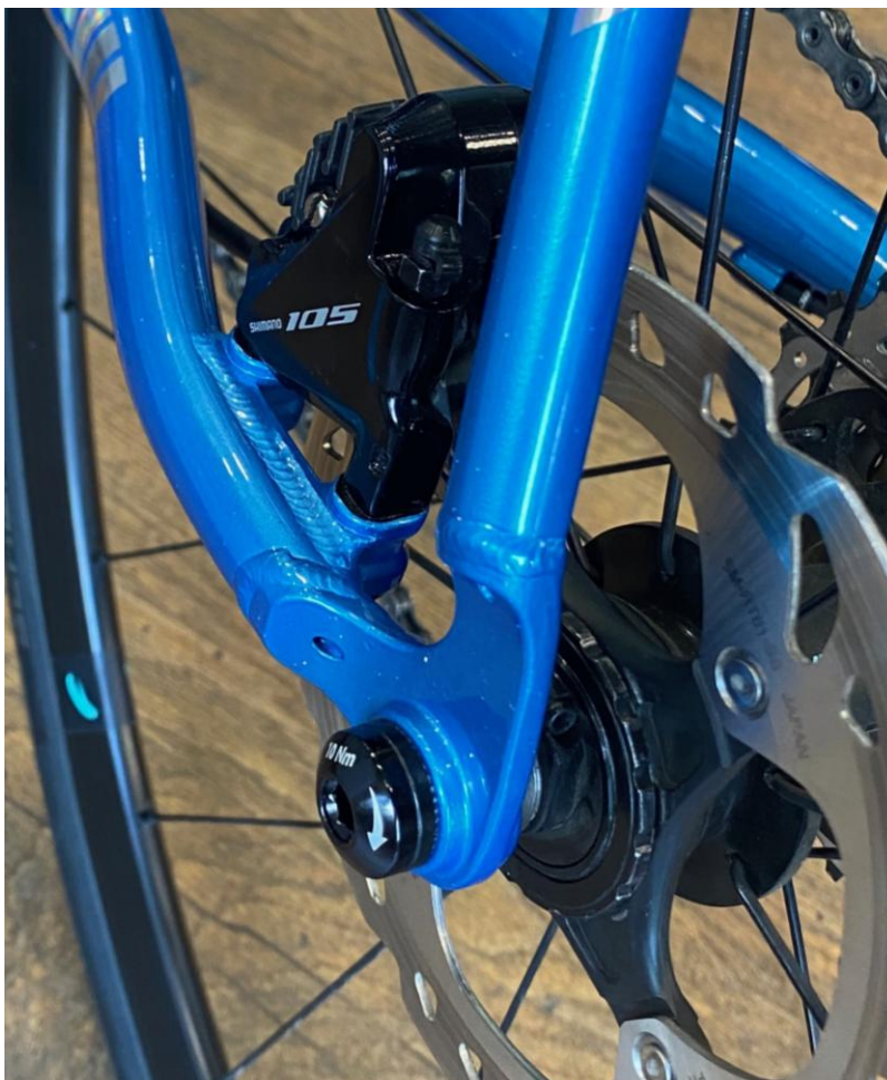
Obrázek 41: Uchycení třmenu brzdy na návarku ocelového kola
