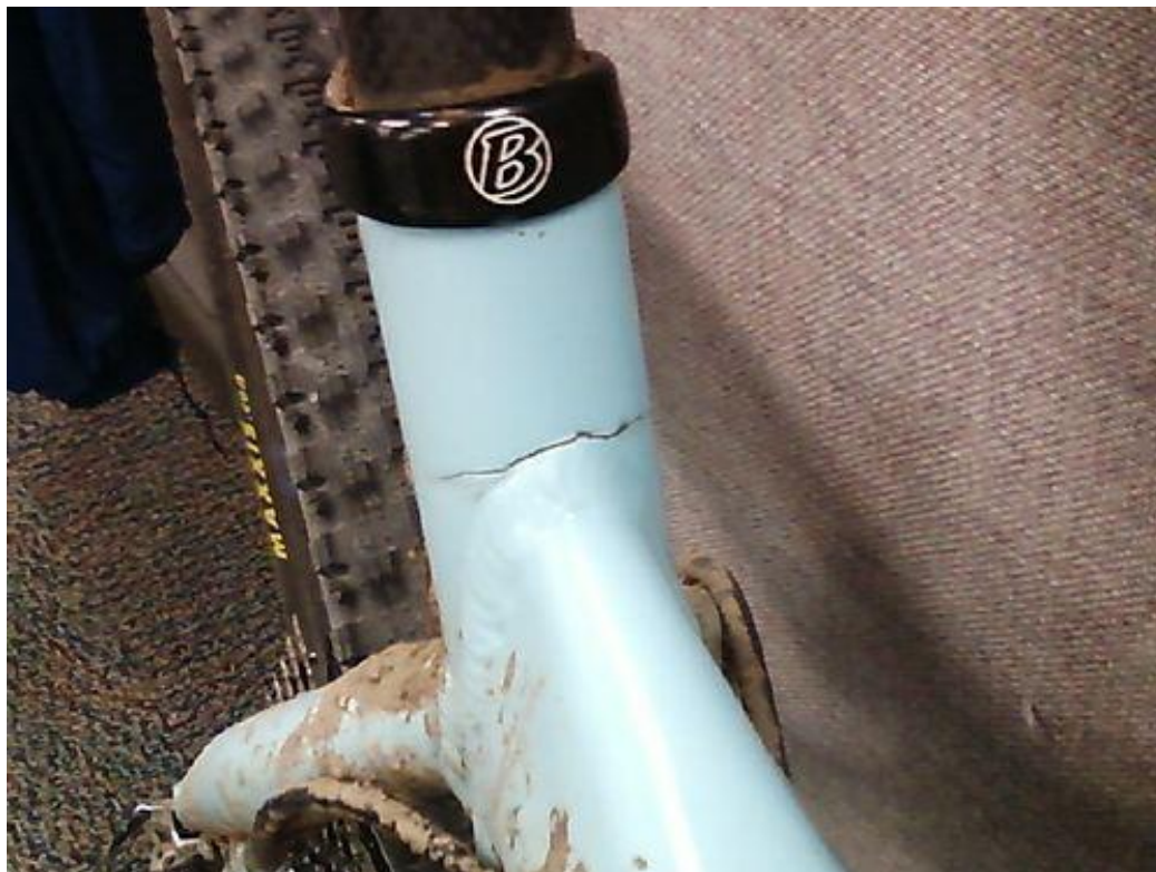
Obrázek 73: Prasklina na sedlové trubce [1]
