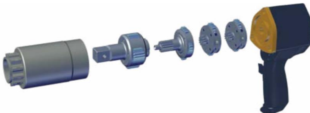
Obrázek 9: Rozstřel elektrického utahováku RAD Torque systém [7]
