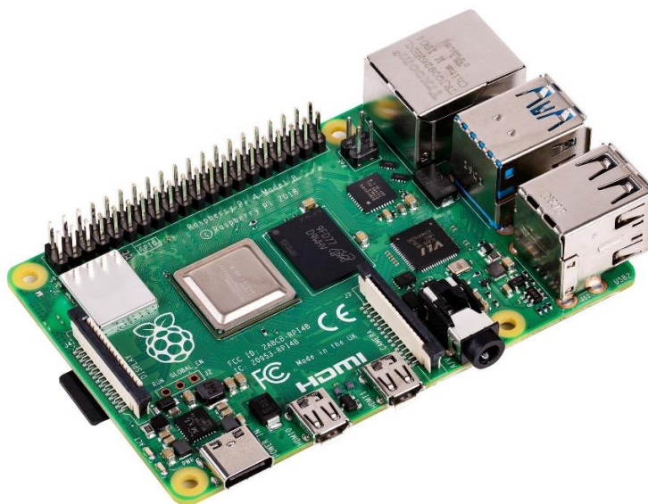
Obrázek 3: Ilustrační obrázek použitého Raspberry Pi 4 Model B. Zdroj [4]
