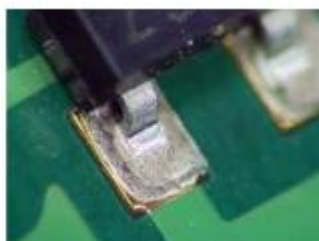
Obr. 19 Spoj vytvořený lepením, převzato z [84].
