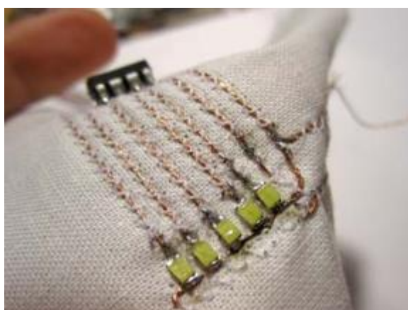
Obr. 24 Měděné vlákno připojené k součástce pájením, převzato z [75].
