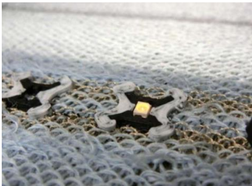
Obr. 28 Vytisknuté pouzdro s vloženou součástkou (vpravo) a bez součástky (vlevo), převzato z [79].
