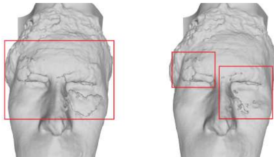
Obrázek 5.4: Artefakty modelu ženy s pohybem (vpravo metoda 2, vlevo metoda 4 potlačující některé artefakty)
