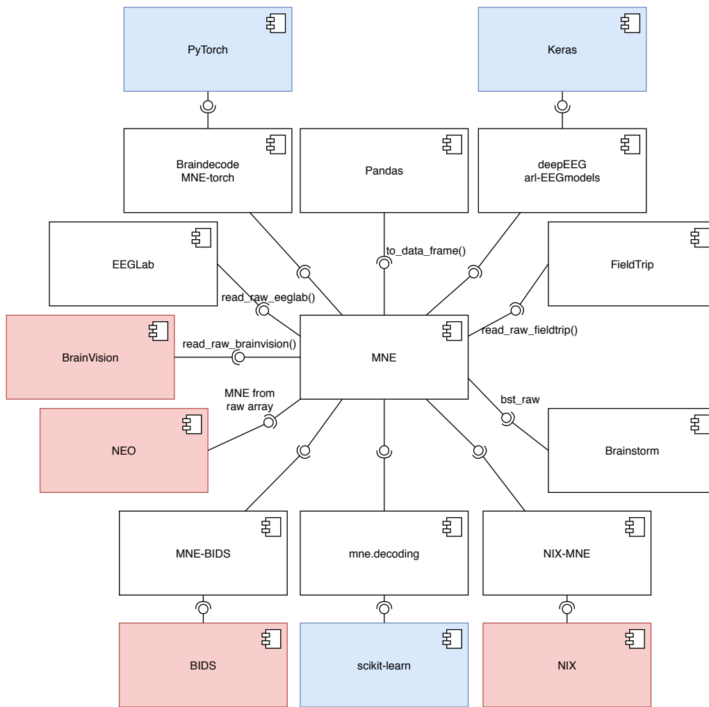
Obrázek 4.7: Integrace nástroje MNE s datovými formáty, analytickými nástroji a knihovnami strojového učení
