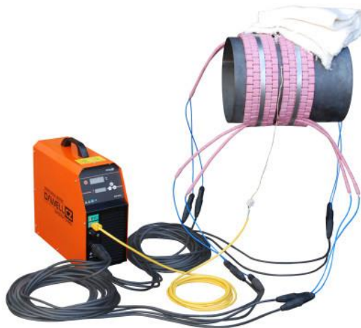
Obrázek 5-5 – Elektro odporové žíhání svaru potrubí [30]
